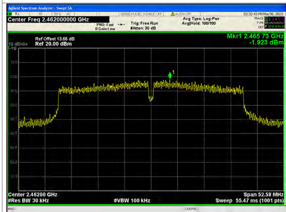
PSD NVNT n40 2462MHz Ant1
