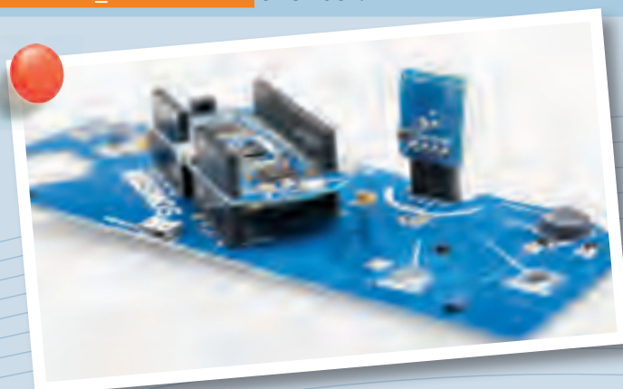
◀ Board mit Temperatursensor
