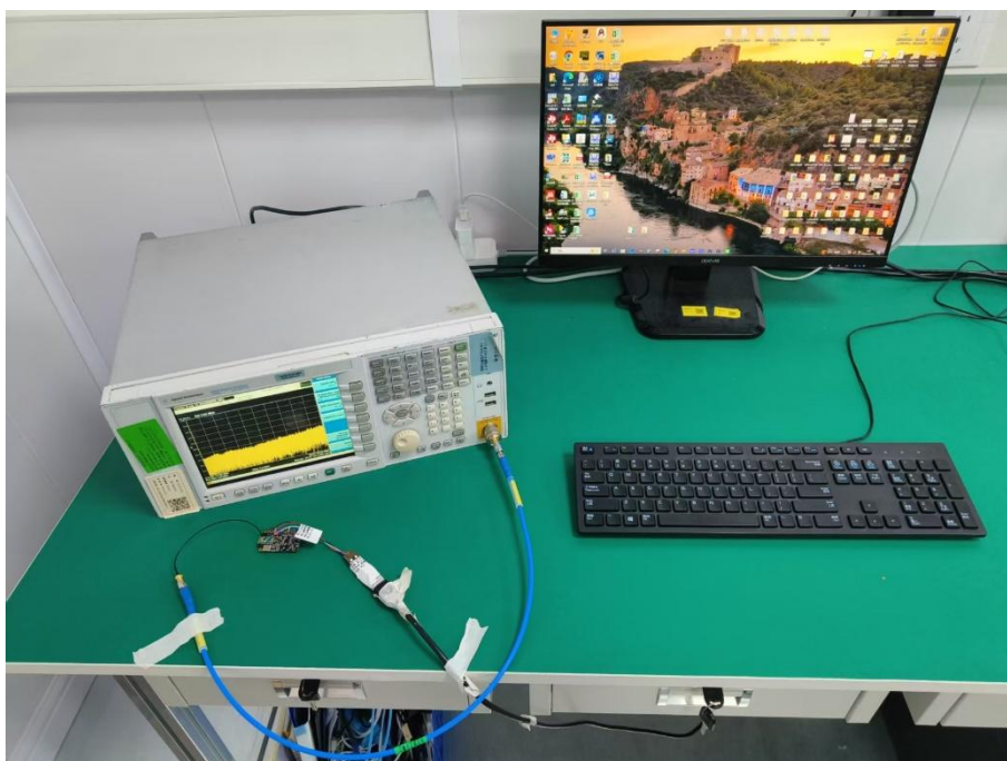
Conducted Test-BT (Wall Rod)
