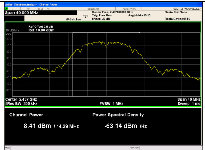
802.11b - AV Output power - Mid CH 2437
