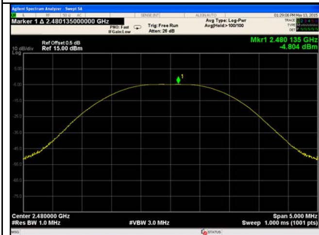
AV Output power - High CH 2480
