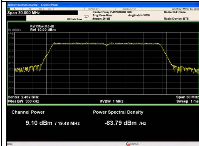
802.11n20 - AV Output power - High CH 2462
