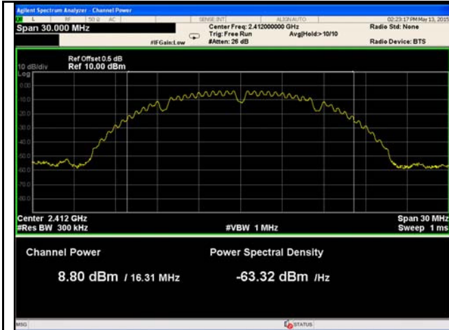
802.11b - AV Output power - Low CH 2412
