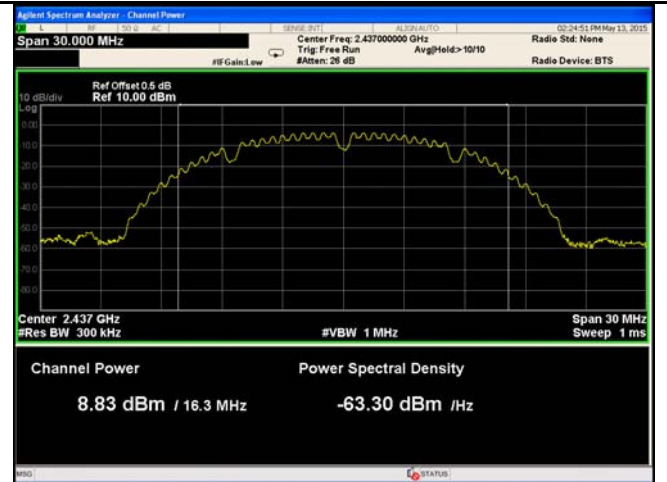
802.11b - AV Output power - Mid CH 2437
