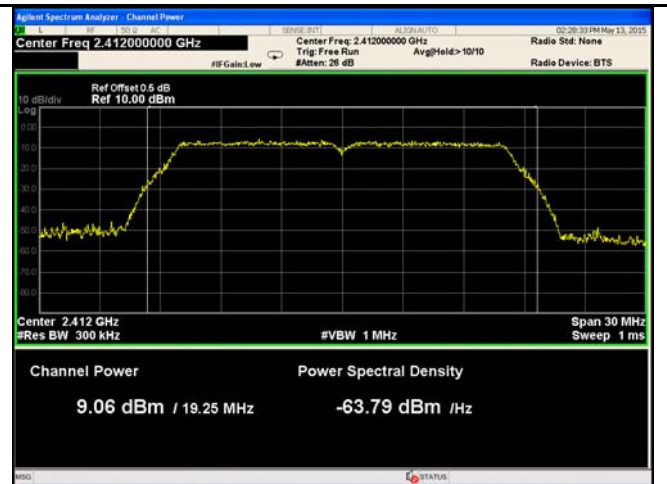
802.11g - AV Output power - Low CH 2412
