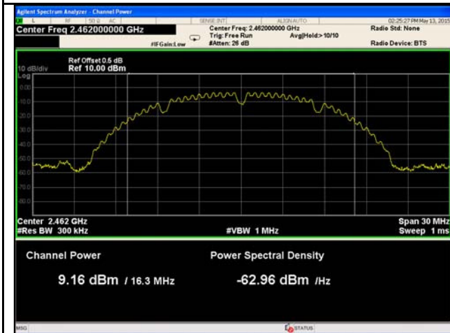
802.11b - AV Output power - High CH 2462
