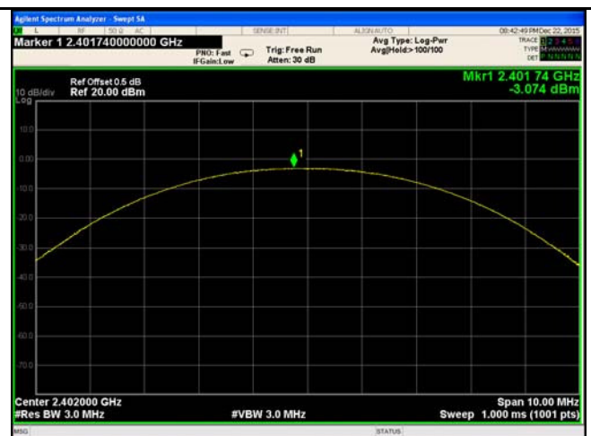
\pi/4 DQPSK Output power - Low CH 2402
