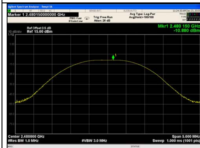
AV Output power - High CH 2480
