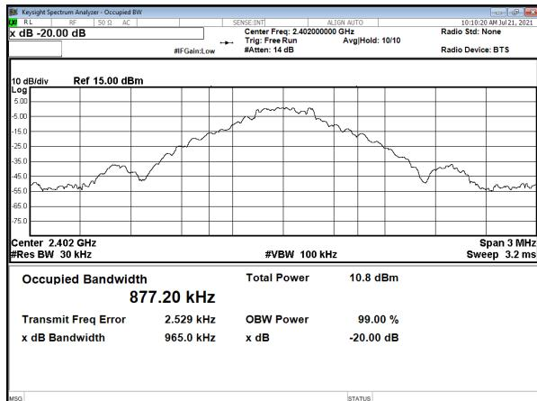
Modulation Type:  $\pi/4$ -DQPSK (2Mbps)
