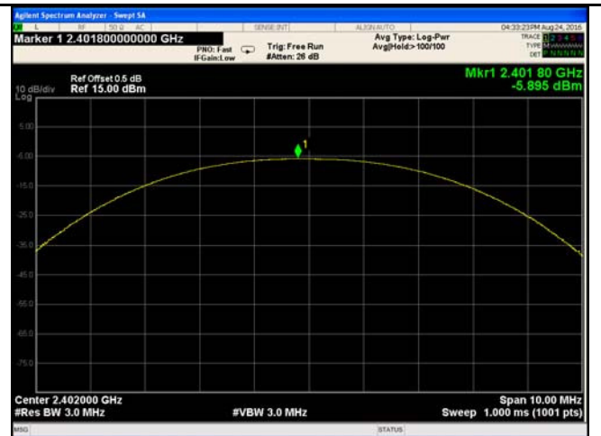
\pi/4 DQPSK Output power - Low CH 2402
