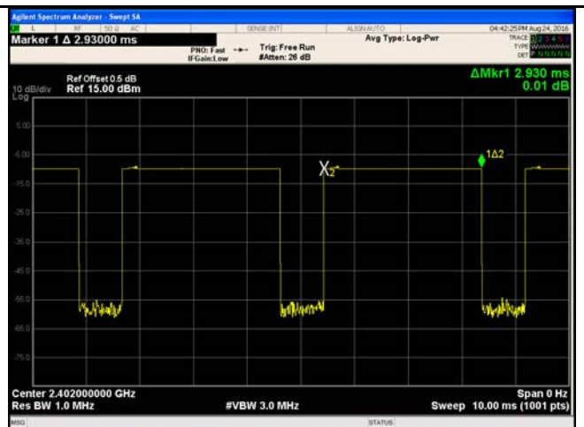
\pi/4 DQPSK - Low CH 2402
