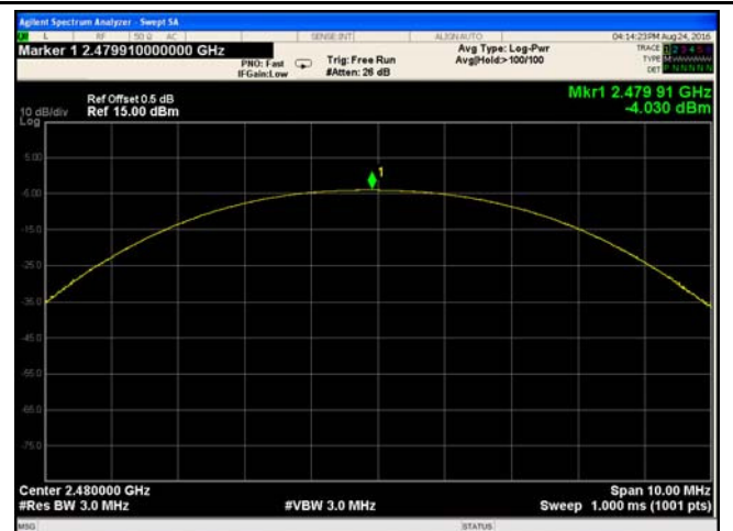
\pi/4 DQPSK Output power - High CH 2480
