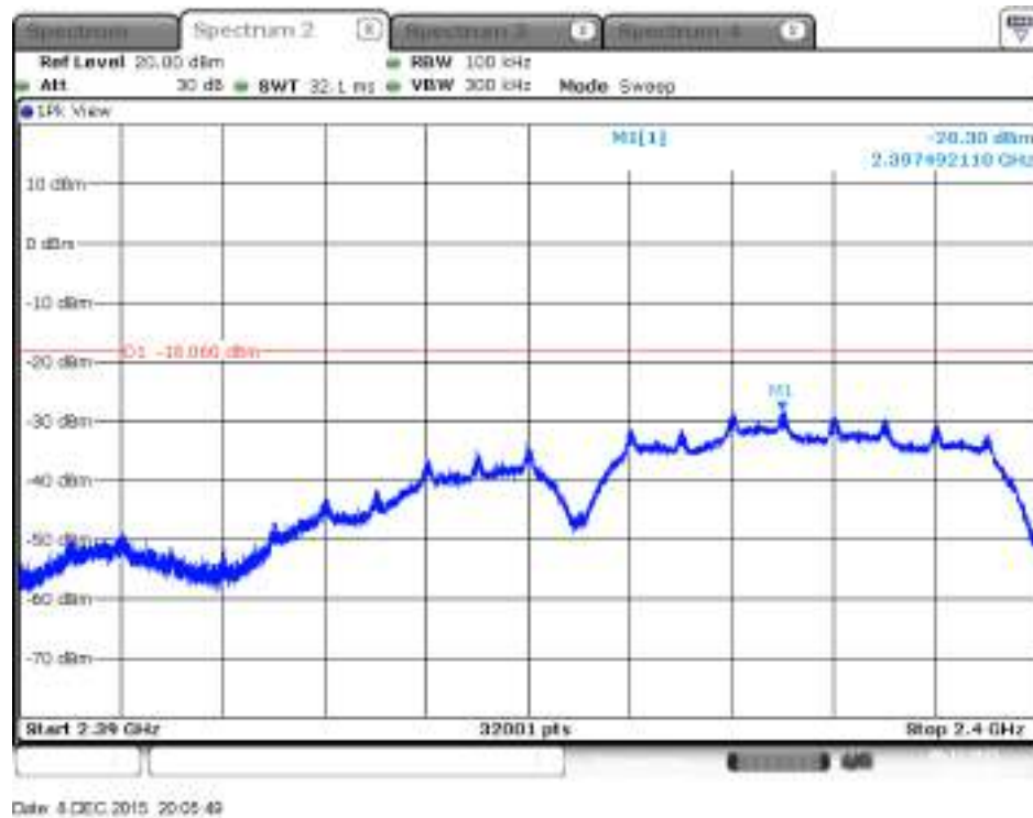
Plot on Configuration IEEE 802.11b / 2412 MHz / 2483.5MHz~2500MHz (down 30dBc) / Chain 2
