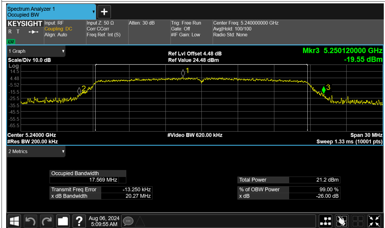
-26dB Bandwidth NVNT n40 5190MHz Ant1
