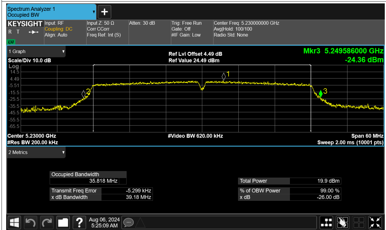
-26dB Bandwidth NVNT n40 5230MHz Ant1
