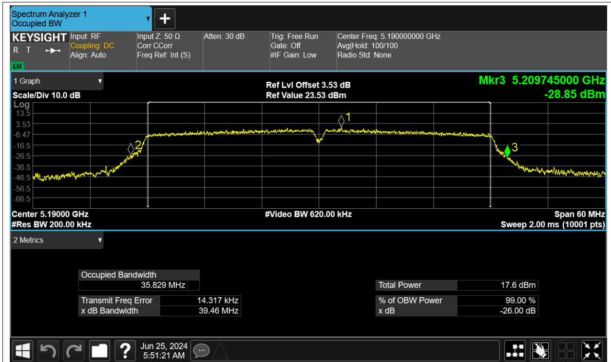
-26dB Bandwidth NVNT n40 5230MHz Ant2
