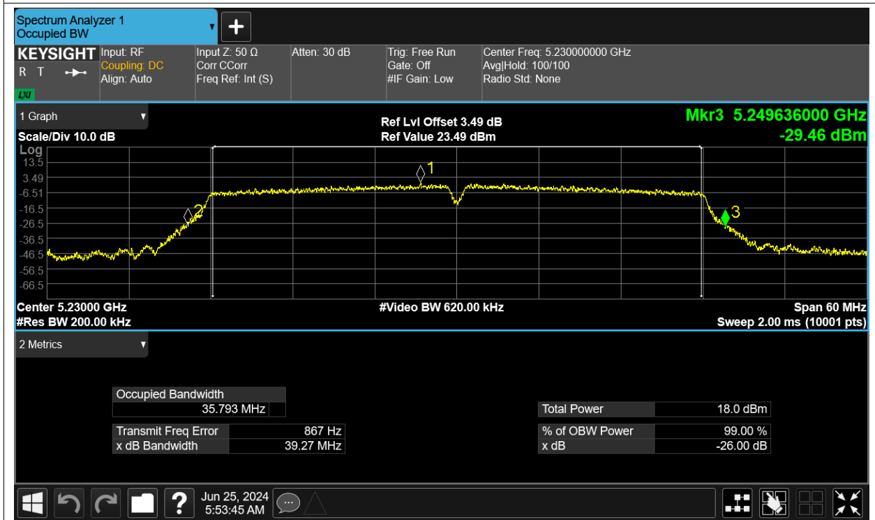
-26dB Bandwidth NVNT n40 5230MHz Ant2
