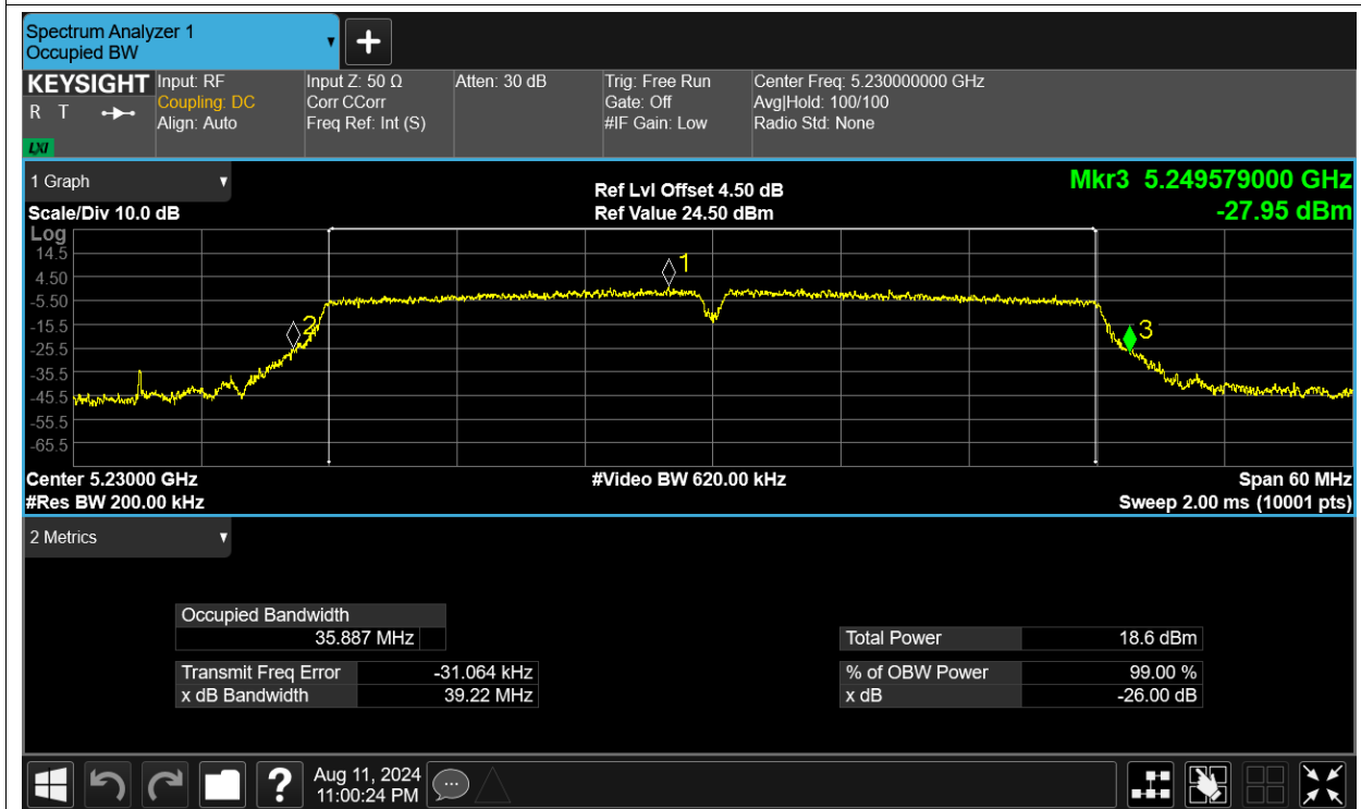
-26dB Bandwidth NVNT ac80 5210MHz Ant1
