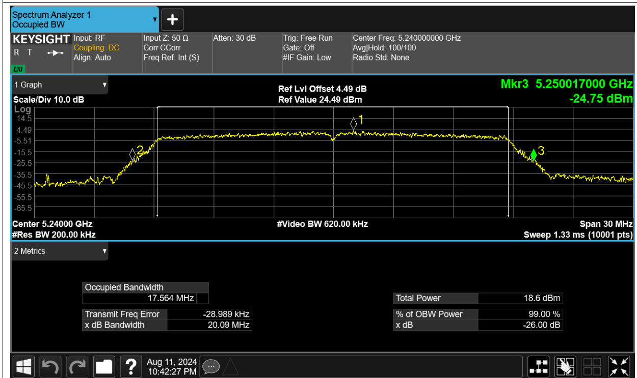
-26dB Bandwidth NVNT n40 5190MHz Ant1
