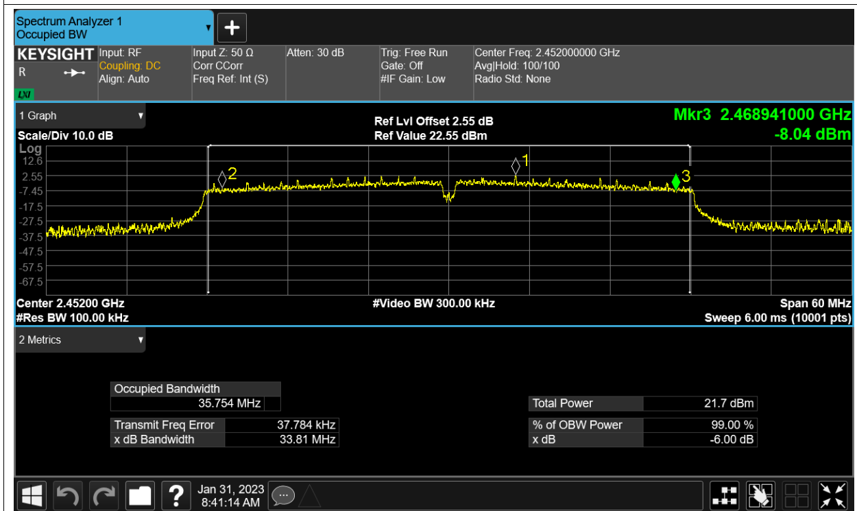
-6dB Bandwidth NVNT n40 2452MHz Ant1
