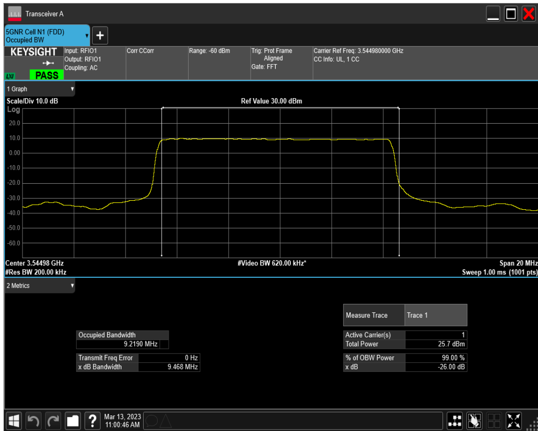
n77(3450-3550) SCS=15kHz DFT_QPSK BW=10MHz Channel=636332 RB=50@0
