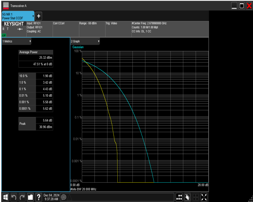
n41 SCS=30kHz DFT_BPSK BW=20MHz Channel=518598 RB=50@0
