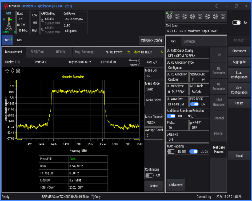
n78(3450-3550) SCS=30kHz DFT_BPSK BW=20MHz Channel=633334 RB=50@0
