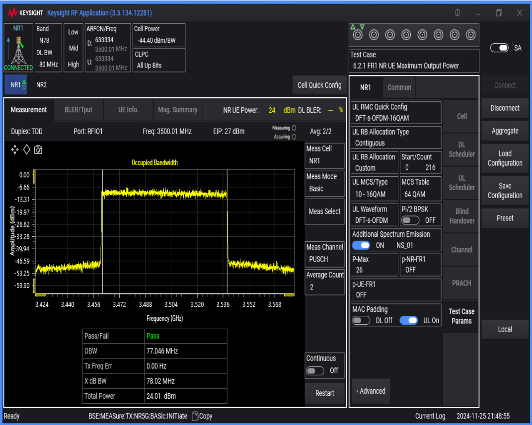
n78(3450-3550) SCS=30kHz DFT_QAM256 BW=20MHz Channel=633334 RB=50@0
