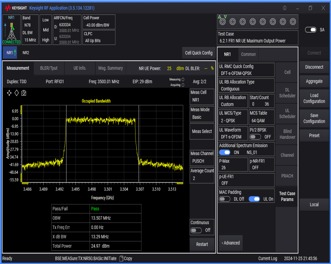
n78(3450-3550) SCS=30kHz DFT_QPSK BW=20MHz Channel=633334 RB=50@0
