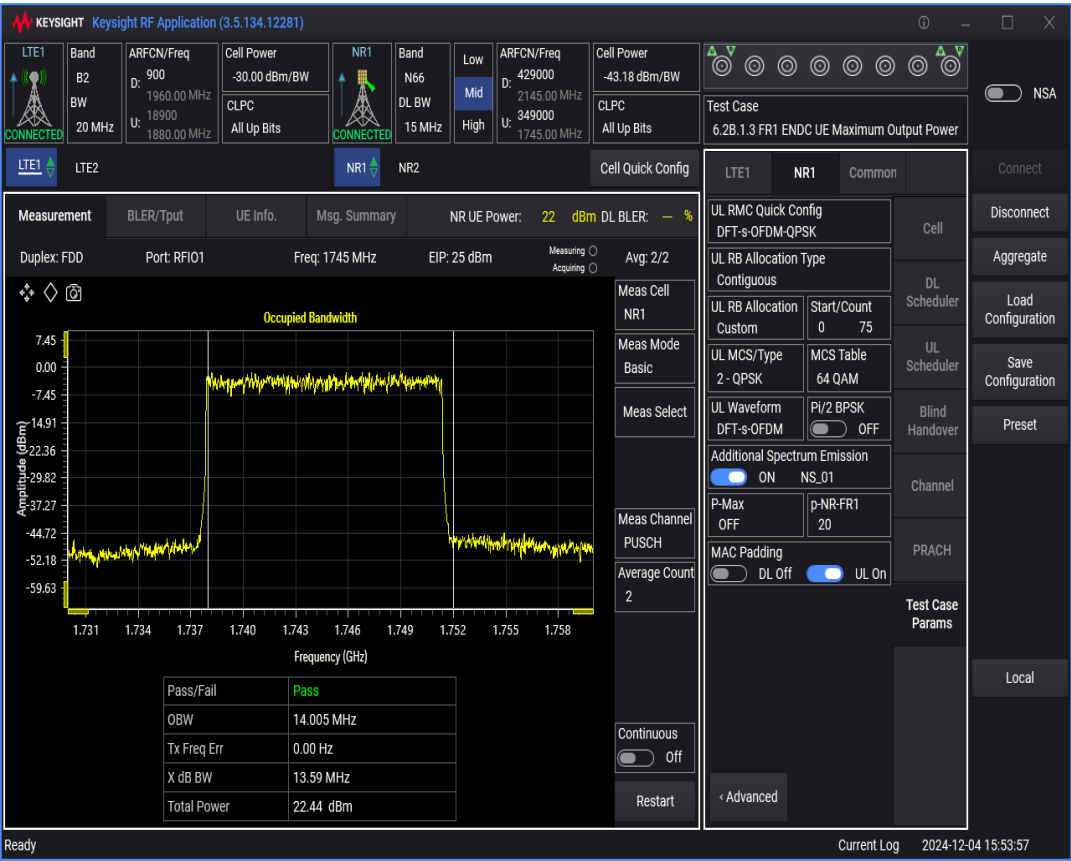
n66 SCS=15kHz DFT_QPSK BW=5MHz Channel=349000 RB=25@0
