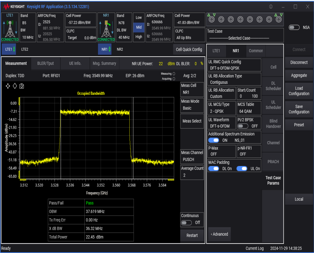
n78 SCS=30kHz DFT_QPSK BW=20MHz Channel=636666 RB=50@0
