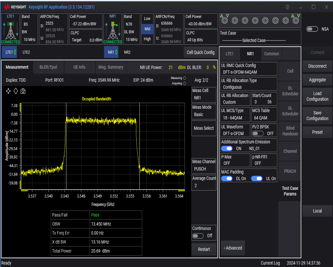
n78 SCS=30kHz DFT_QAM64 BW=20MHz Channel=636666 RB=50@0
