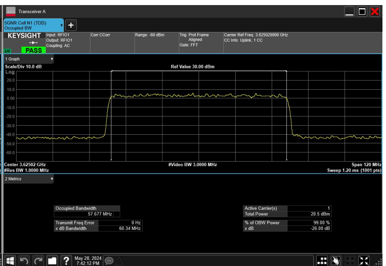
60MHz_30kHz_3625MHz_DFT-s-OFDM \pi/2 BPSK_RB162@0
