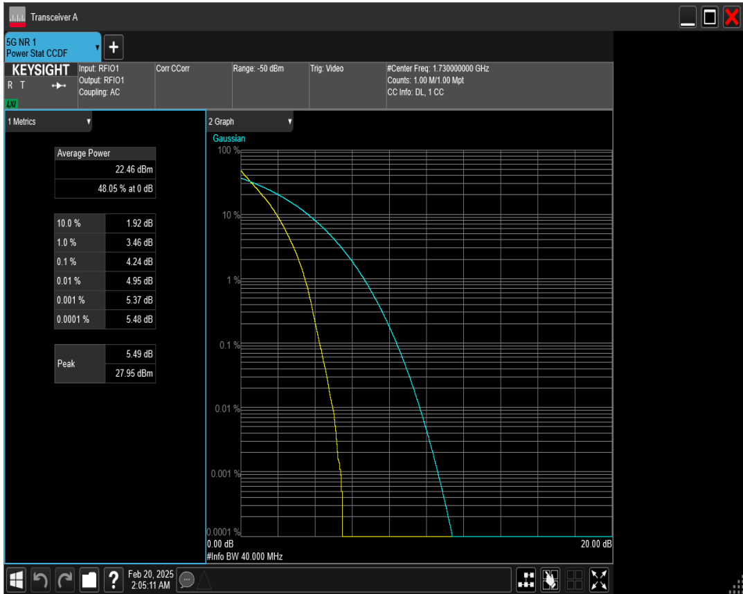
n66 SCS=15kHz DFT_BPSK BW=20MHz Channel=354000 RB=100@0
