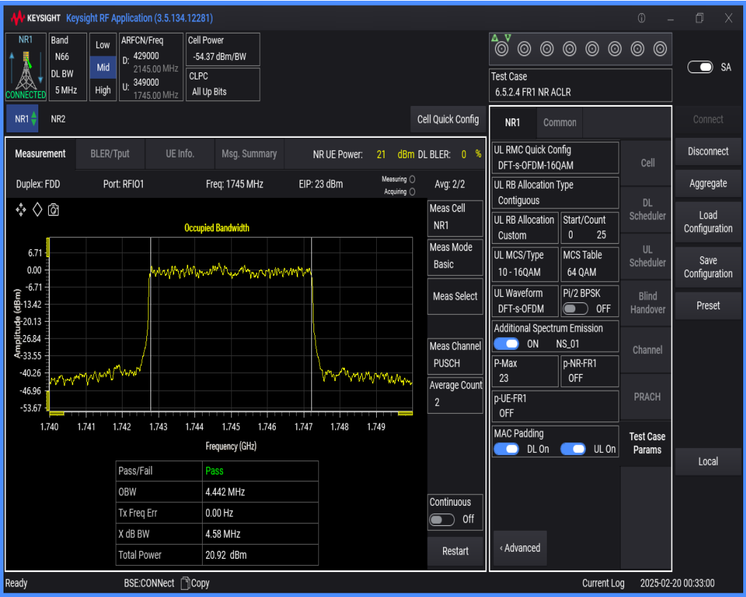
n66 SCS=15kHz DFT_QAM256 BW=10MHz Channel=349000 RB=50@0
