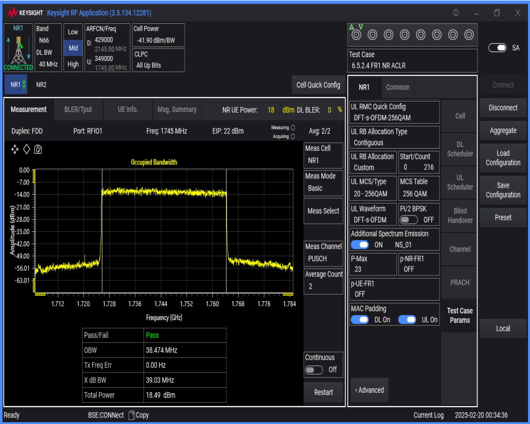
n66 SCS=15kHz DFT_QAM256 BW=20MHz Channel=349000 RB=100@0
