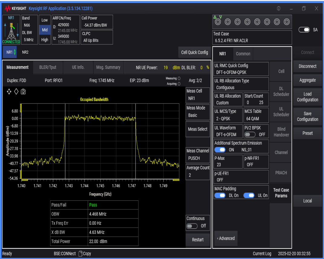
n66 SCS=15kHz DFT_QPSK BW=40MHz Channel=349000 RB=216@0
