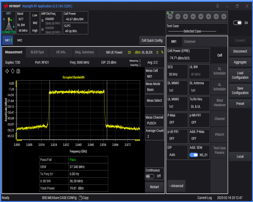
n77(3700-3980) SCS=30kHz DFT_QAM256 BW=20MHz Channel=656000 RB=50@0
