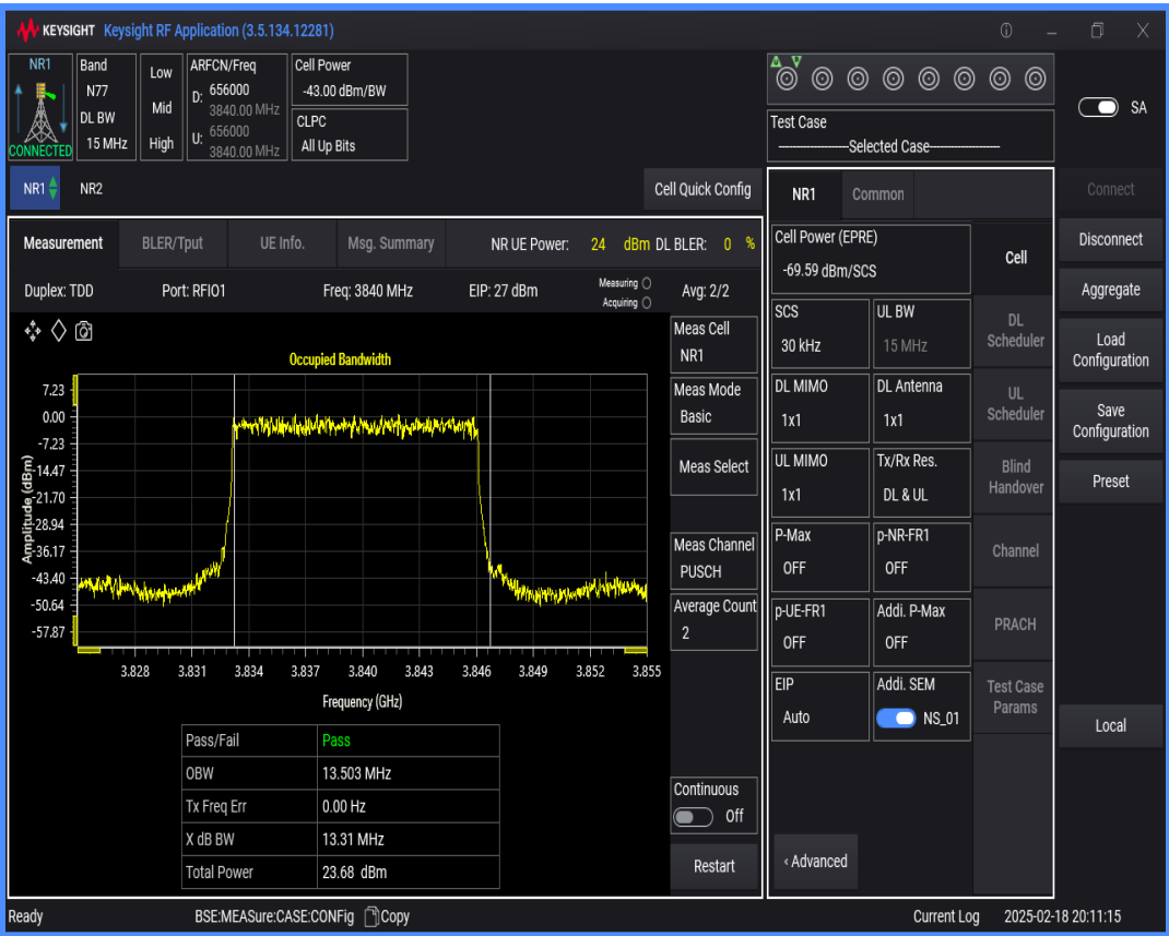
n77(3700-3980) SCS=30kHz DFT_BPSK BW=20MHz Channel=656000 RB=50@0
