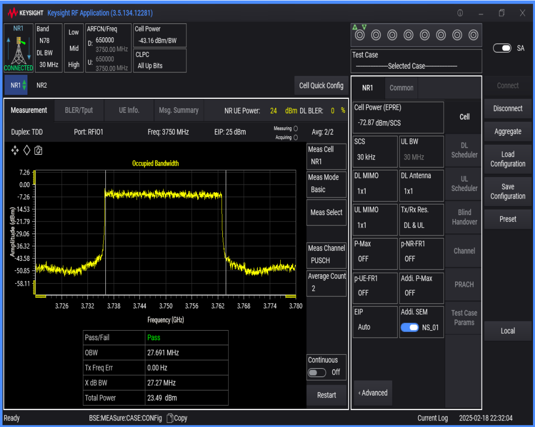
n78(3700-3800) SCS=30kHz DFT_BPSK BW=20MHz Channel=650000 RB=50@0
