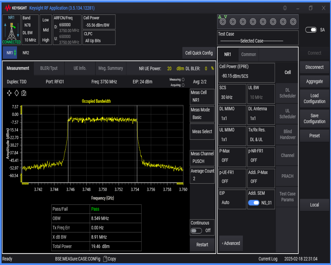
n78(3700-3800) SCS=30kHz DFT_QAM256 BW=20MHz Channel=650000 RB=50@0
