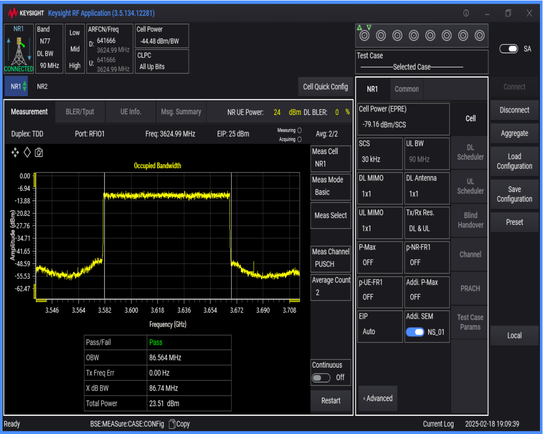
n77(3550-3700) SCS=30kHz DFT_QAM16 BW=20MHz Channel=641666 RB=50@0
