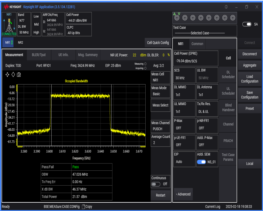
n77(3550-3700) SCS=30kHz DFT_QAM64 BW=20MHz Channel=641666 RB=50@0
