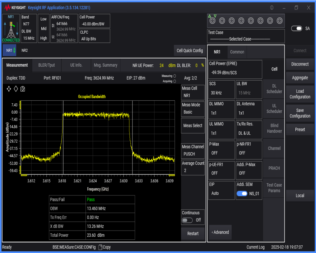
n77(3550-3700) SCS=30kHz DFT_BPSK BW=20MHz Channel=641666 RB=50@0
