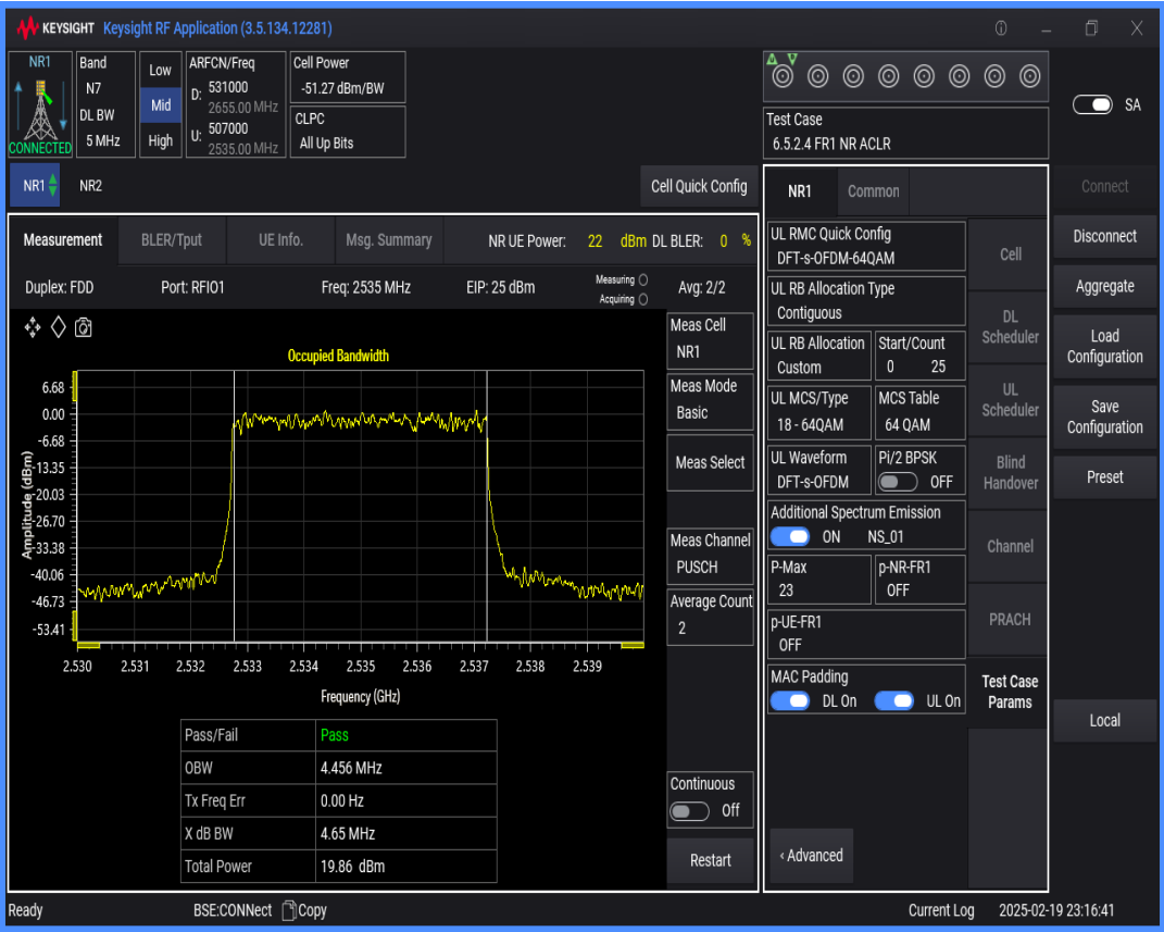
n7 SCS=15kHz DFT_QPSK BW=10MHz Channel=507000 RB=50@0
