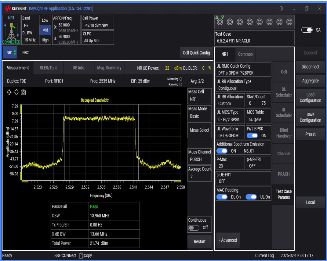
n7 SCS=15kHz DFT_BPSK BW=20MHz Channel=507000 RB=100@0
