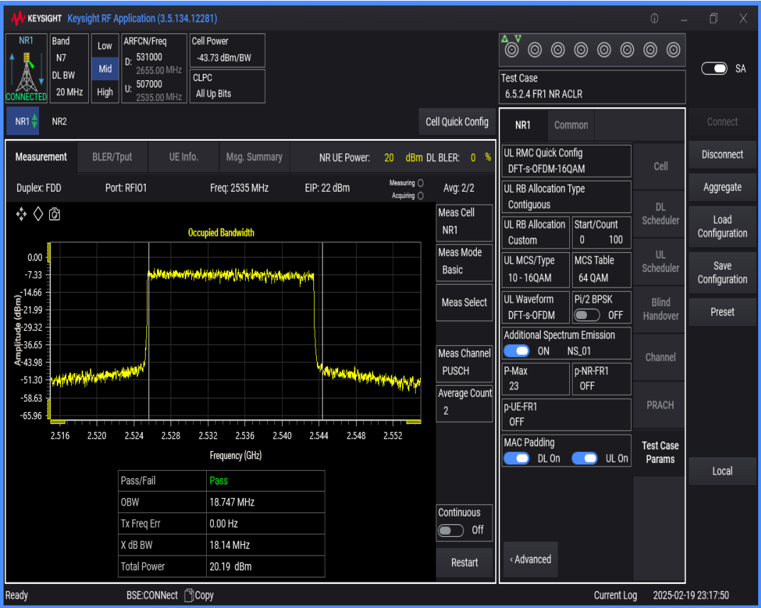
n7 SCS=15kHz DFT_QAM256 BW=10MHz Channel=507000 RB=50@0
