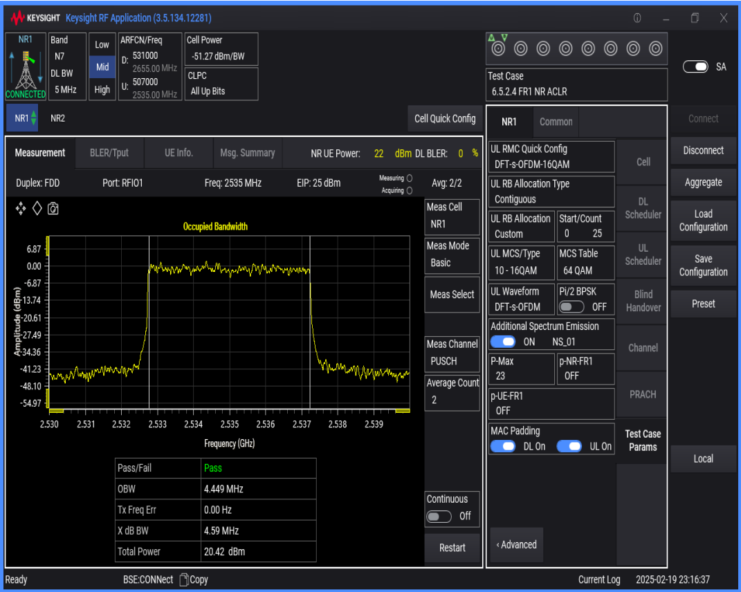
n7 SCS=15kHz DFT_QAM256 BW=20MHz Channel=507000 RB=100@0
