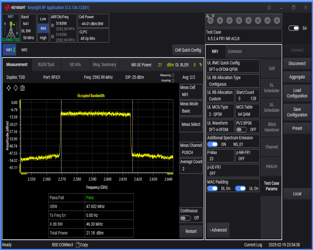
n41 SCS=30kHz DFT_QPSK BW=40MHz Channel=518598 RB=100@0
