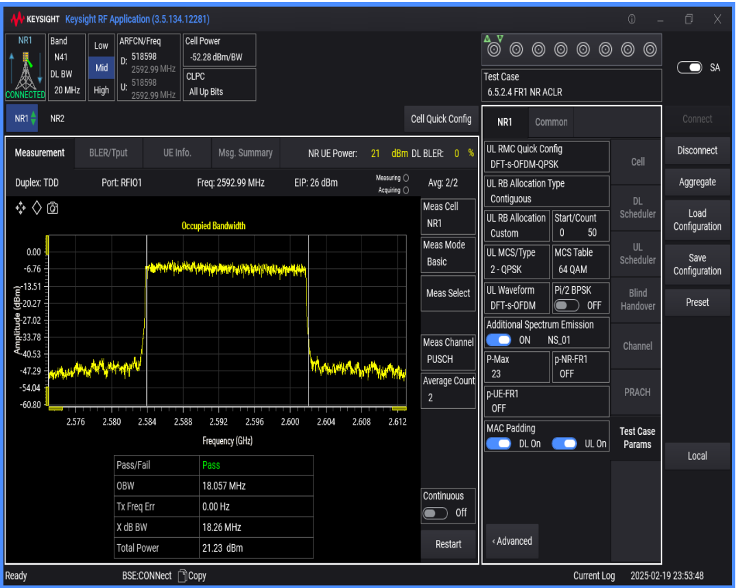
n41 SCS=30kHz DFT_QPSK BW=50MHz Channel=518598 RB=128@0
