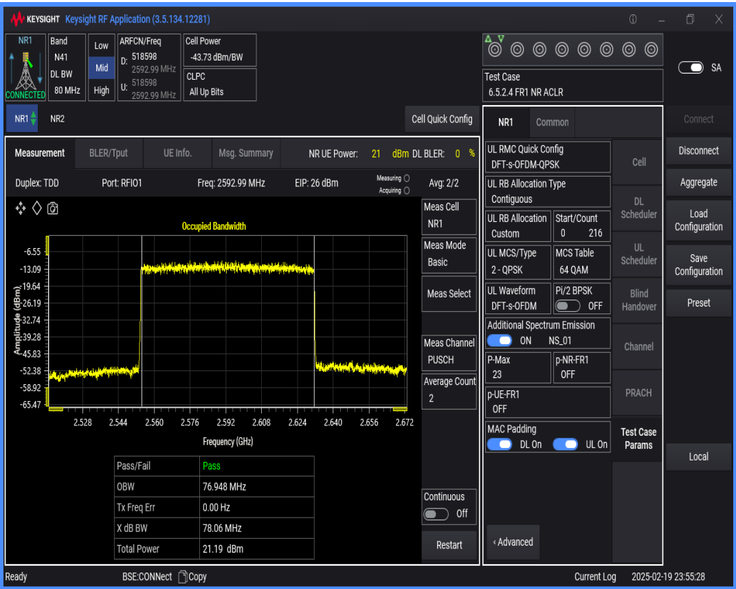
n41 SCS=30kHz DFT_QPSK BW=90MHz Channel=518598 RB=240@0
