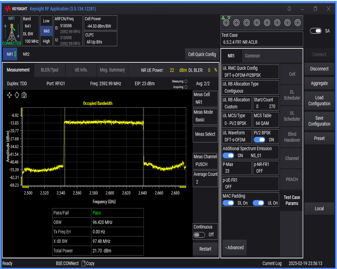
n41 SCS=30kHz DFT_BPSK BW=40MHz Channel=518598 RB=100@0
