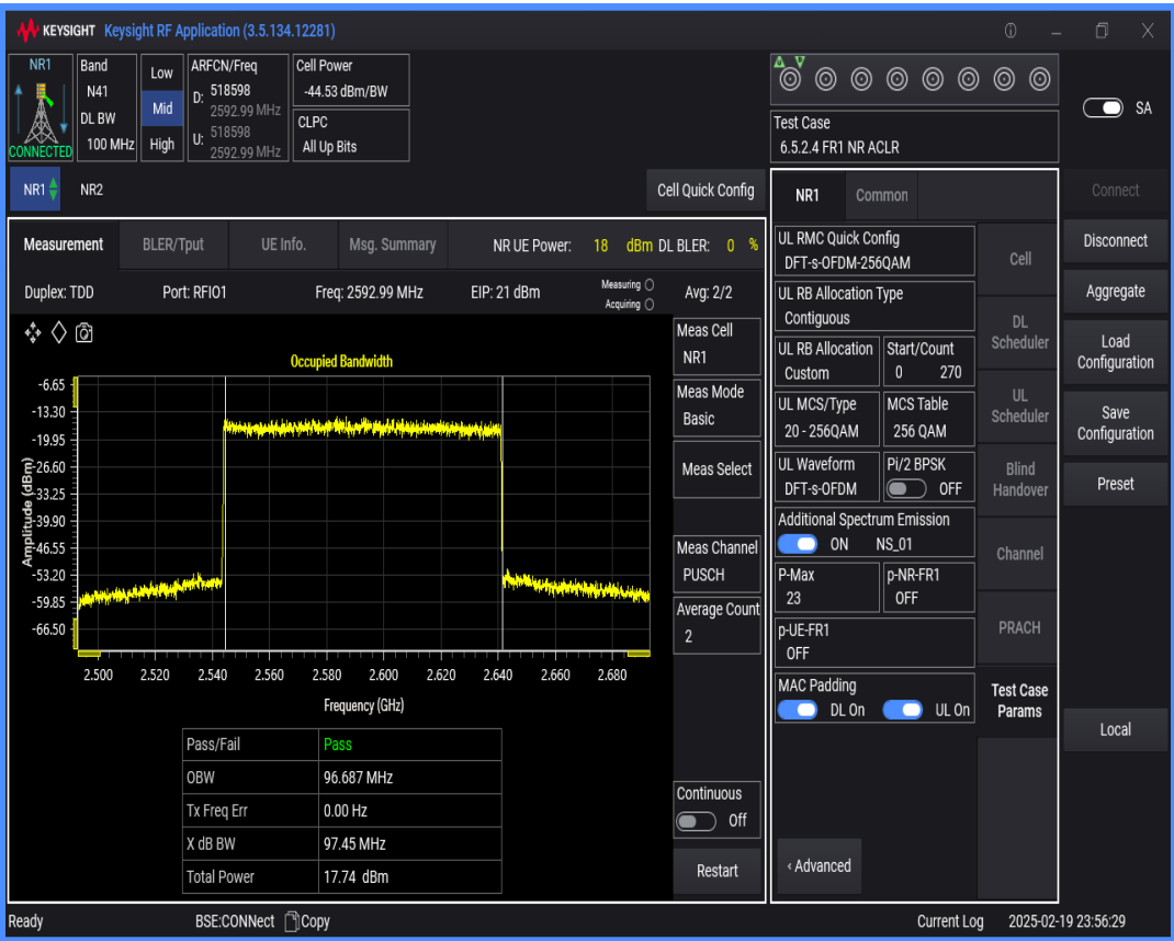
n41 SCS=30kHz DFT_QAM256 BW=20MHz Channel=518598 RB=50@0
