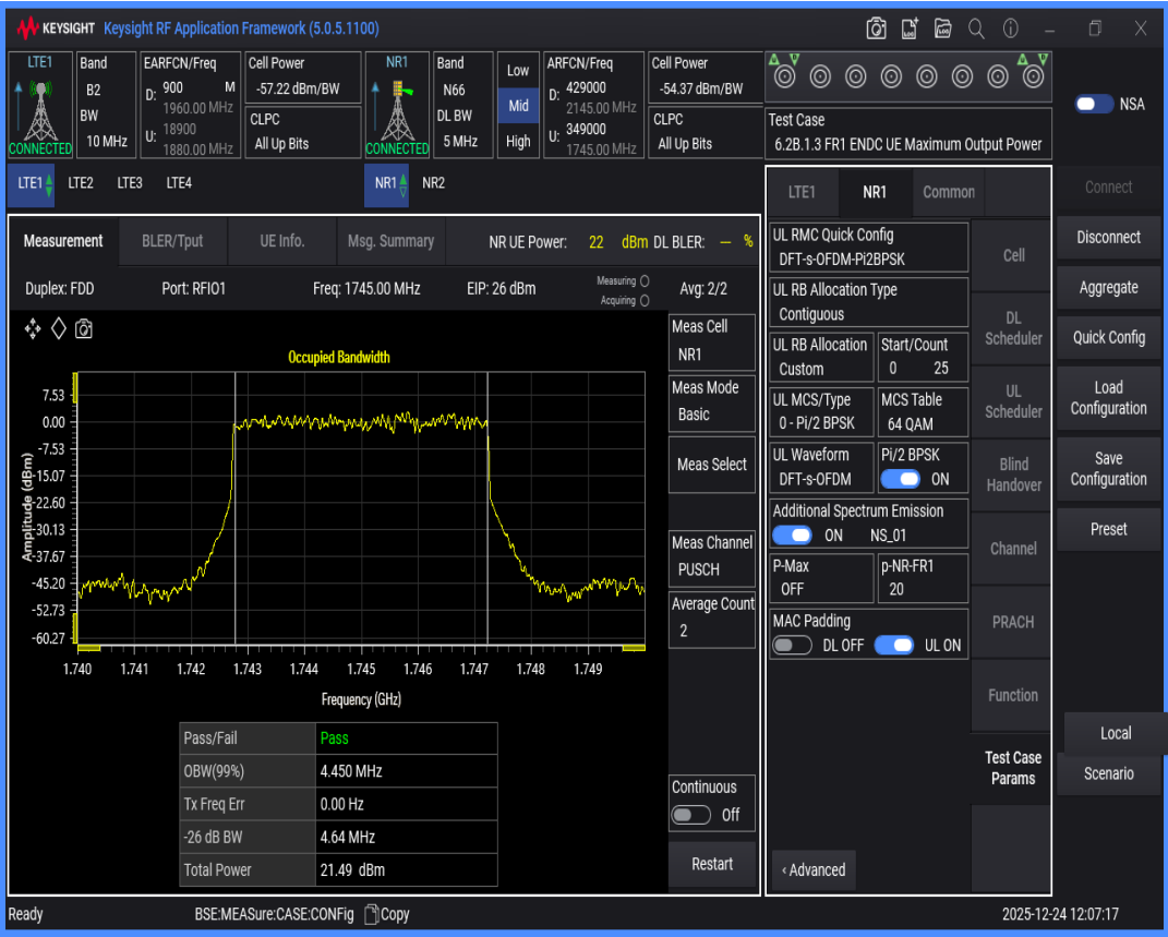
n66 SCS=15kHz DFT_QAM16 BW=10MHz Channel=349000 RB=50@0
