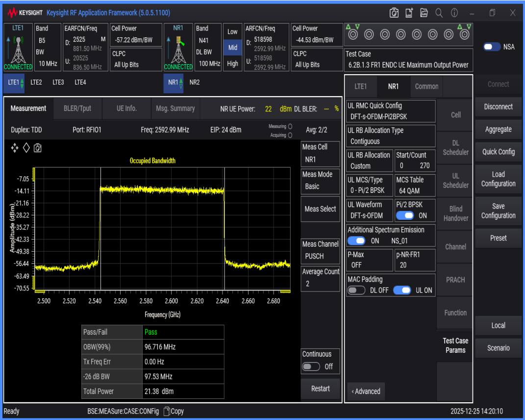
n41 SCS=30kHz DFT_BPSK BW=20MHz Channel=518598 RB=50@0
