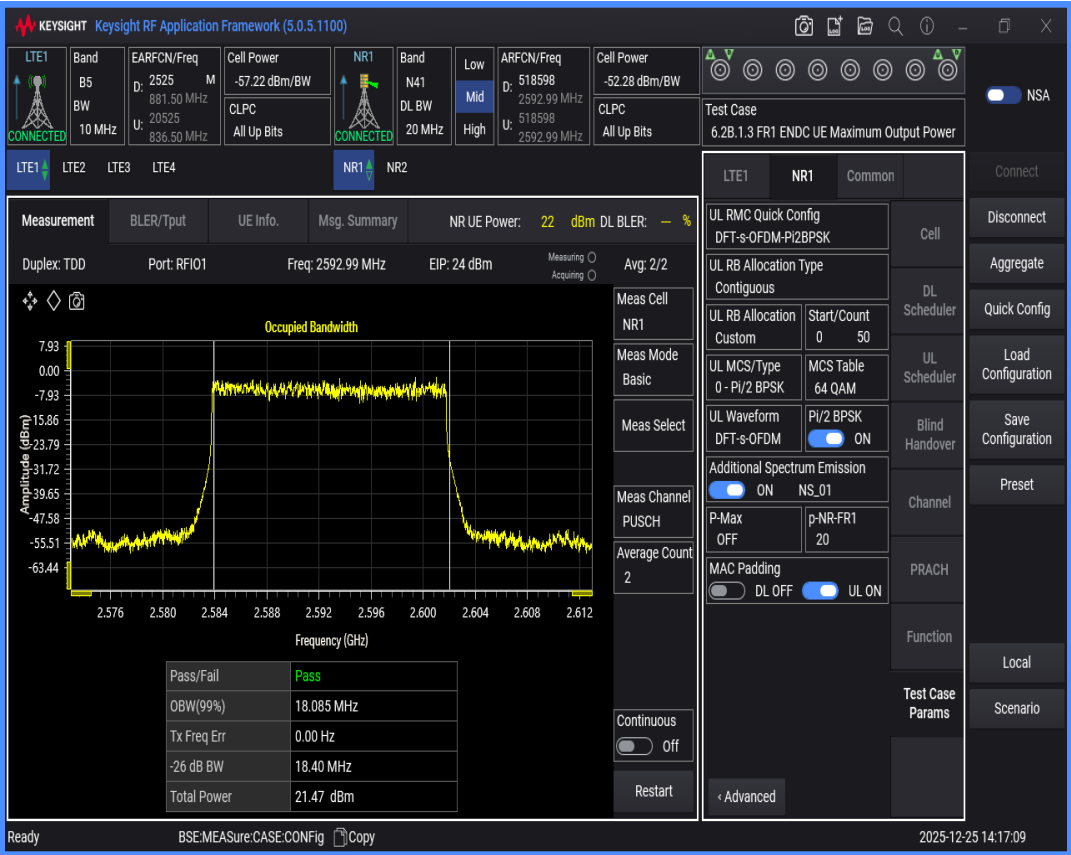
n41 SCS=30kHz DFT_BPSK BW=40MHz Channel=518598 RB=100@0
