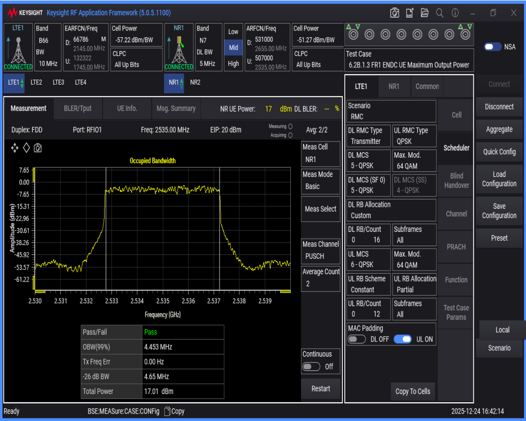
n7 SCS=15kHz DFT_QAM16 BW=10MHz Channel=507000 RB=50@0
