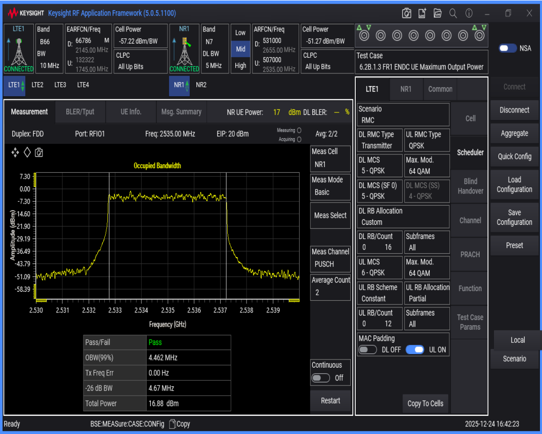
n7 SCS=15kHz DFT_QAM256 BW=10MHz Channel=507000 RB=50@0
