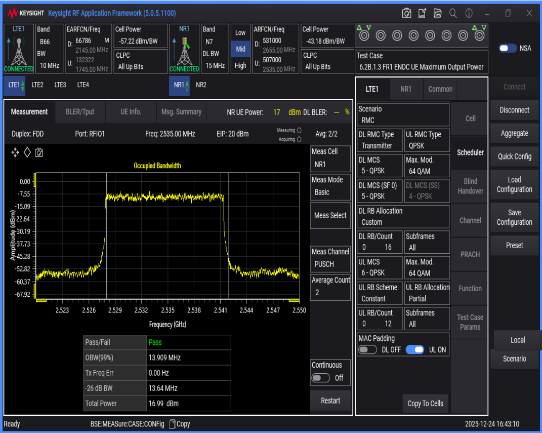
n7 SCS=15kHz DFT_BPSK BW=20MHz Channel=507000 RB=100@0
