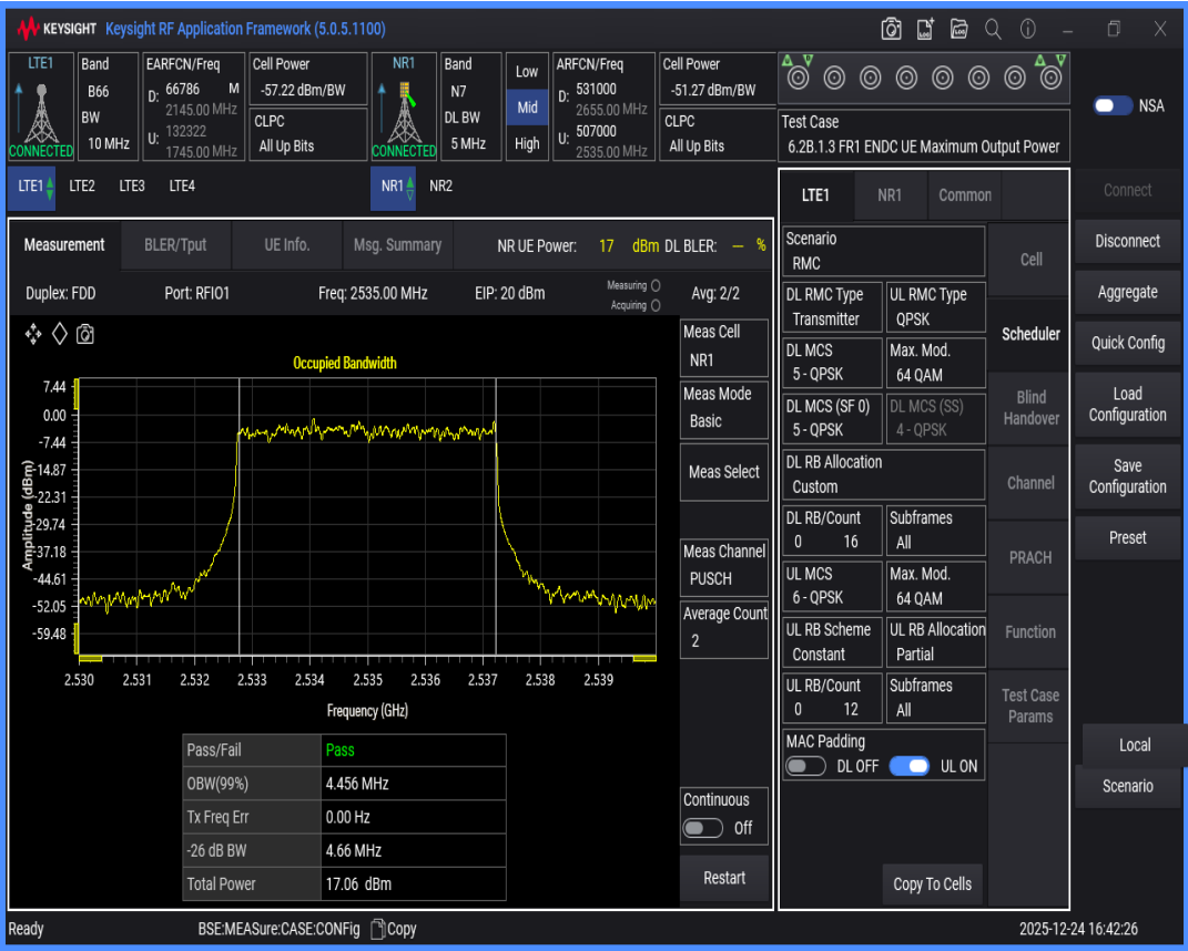
n7 SCS=15kHz DFT_QPSK BW=10MHz Channel=507000 RB=50@0
