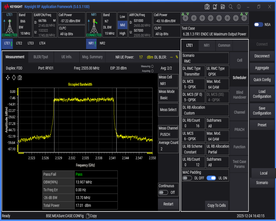
n7 SCS=15kHz DFT_QPSK BW=20MHz Channel=507000 RB=100@0
