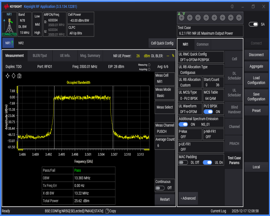
n78(3450-3550) SCS=30kHz DFT_BPSK BW=20MHz Channel=633334 RB=50@0
