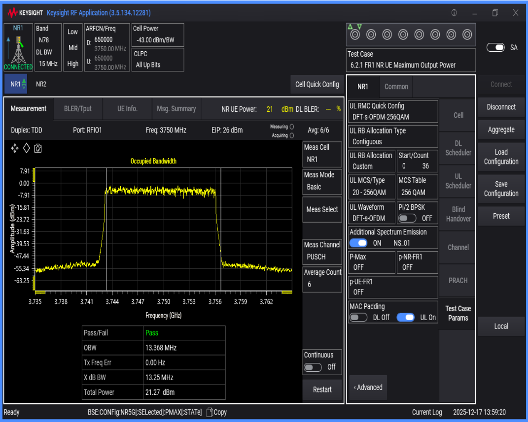
n78(3700-3800) SCS=30kHz DFT_QAM256 BW=20MHz Channel=650000 RB=50@0
