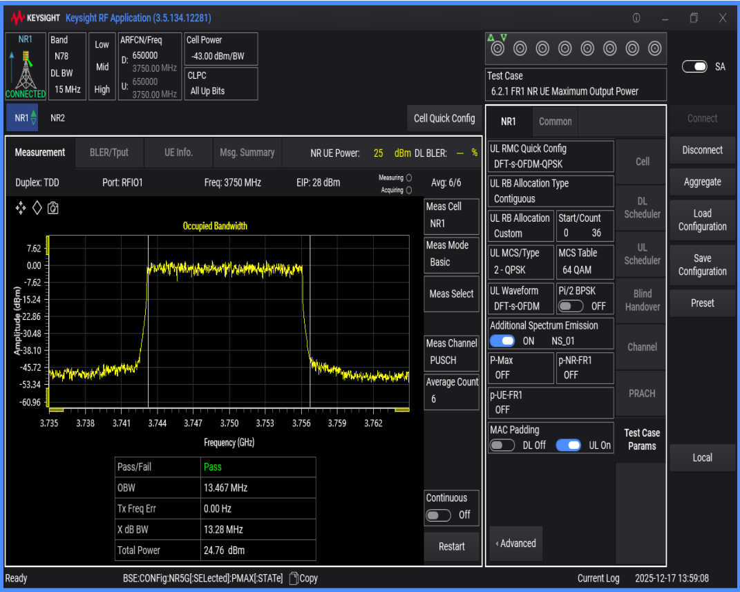
n78(3700-3800) SCS=30kHz DFT_QPSK BW=20MHz Channel=650000 RB=50@0
