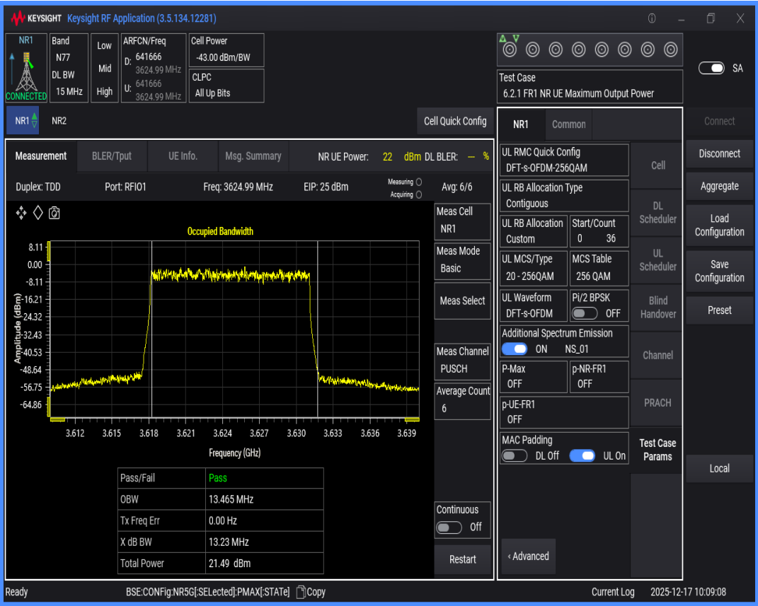
n77(3550-3700) SCS=30kHz DFT_QAM256 BW=20MHz Channel=641666 RB=50@0
