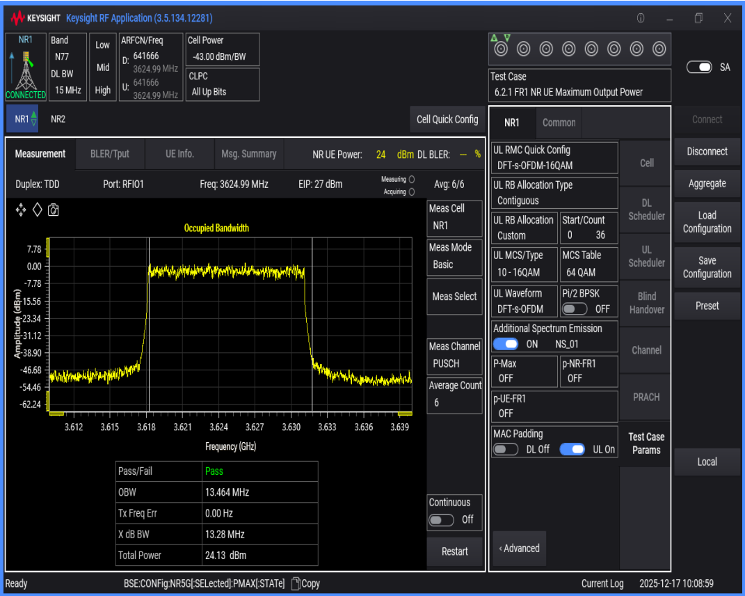
n77(3550-3700) SCS=30kHz DFT_QAM16 BW=20MHz Channel=641666 RB=50@0
