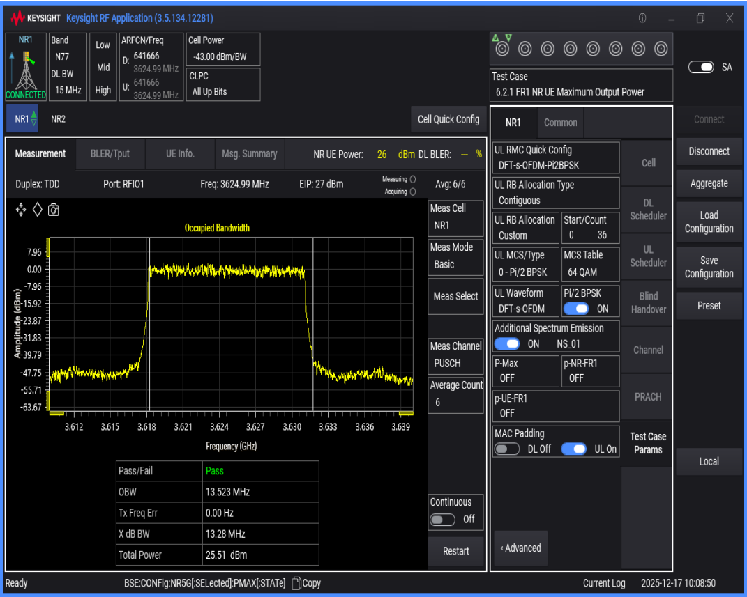
n77(3550-3700) SCS=30kHz DFT_BPSK BW=20MHz Channel=641666 RB=50@0
