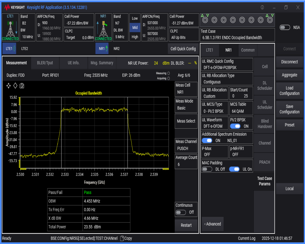
n7 SCS=15kHz DFT_QAM16 BW=10MHz Channel=507000 RB=50@0
