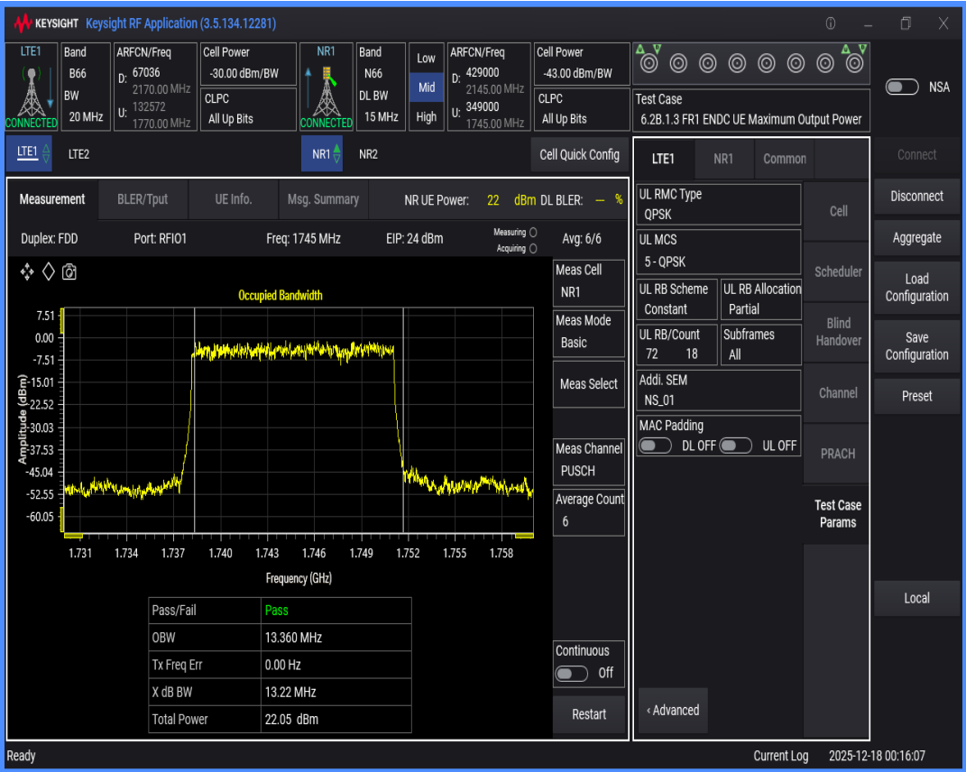
n66 SCS=30kHz DFT_BPSK BW=20MHz Channel=349000 RB=50@0
