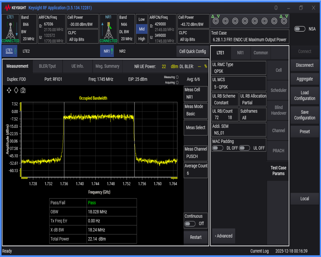
n66 SCS=30kHz DFT_QPSK BW=40MHz Channel=349000 RB=100@0
