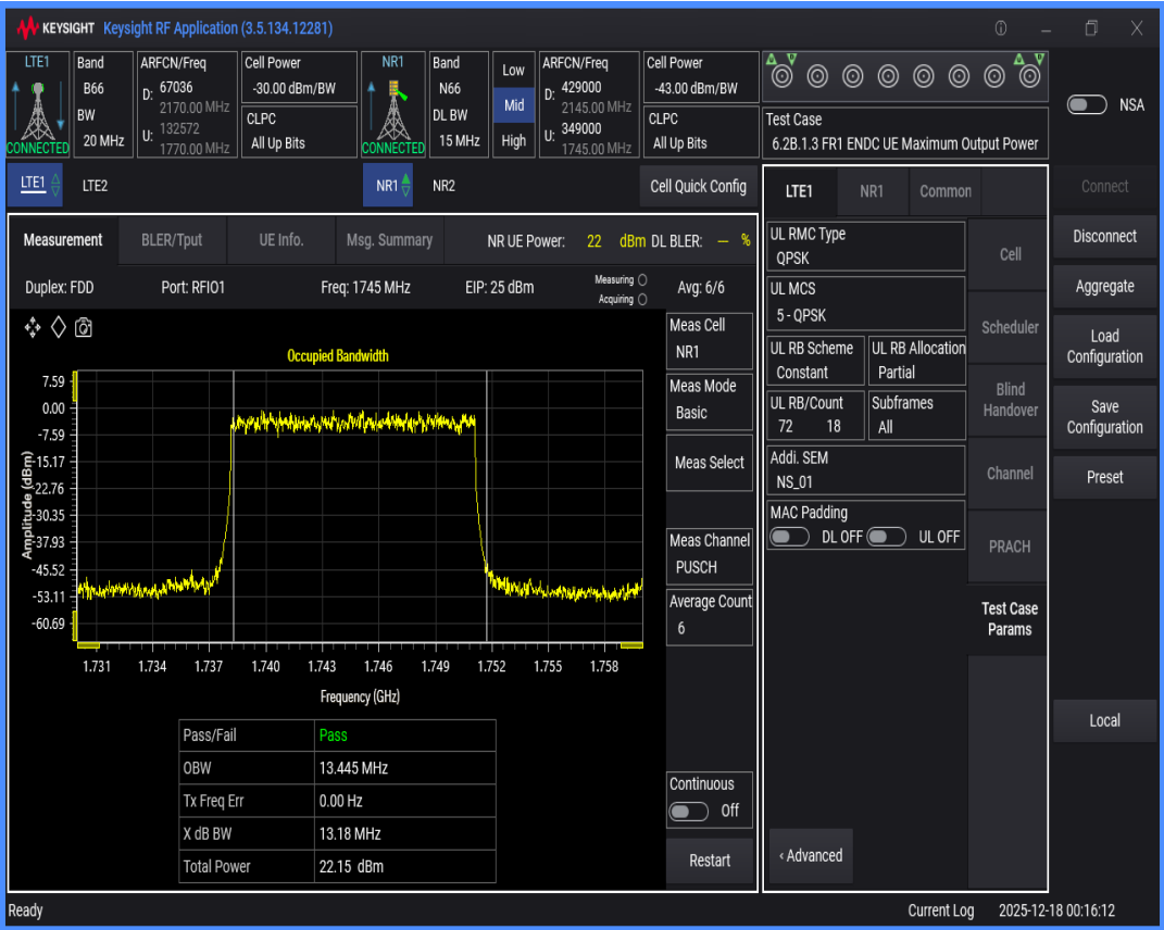
n66 SCS=30kHz DFT_QPSK BW=20MHz Channel=349000 RB=50@0
