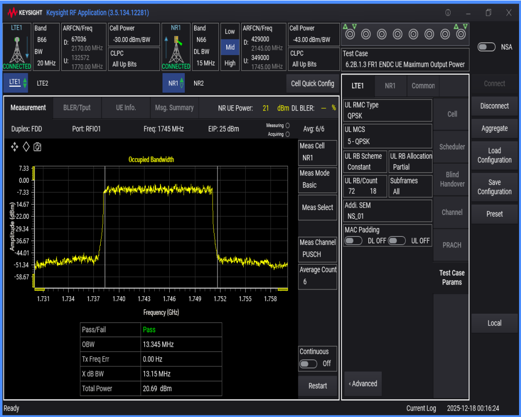
n66 SCS=30kHz DFT_QAM256 BW=20MHz Channel=349000 RB=50@0
