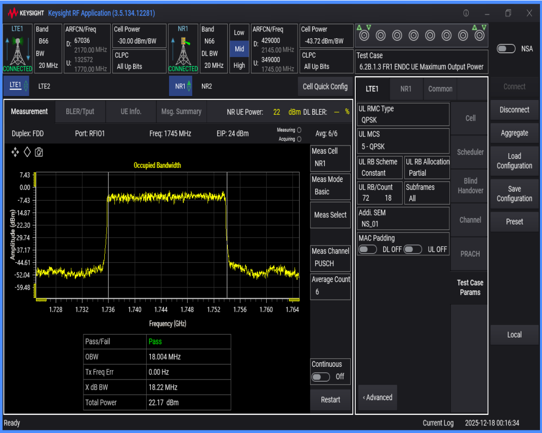
n66 SCS=30kHz DFT_BPSK BW=40MHz Channel=349000 RB=100@0
