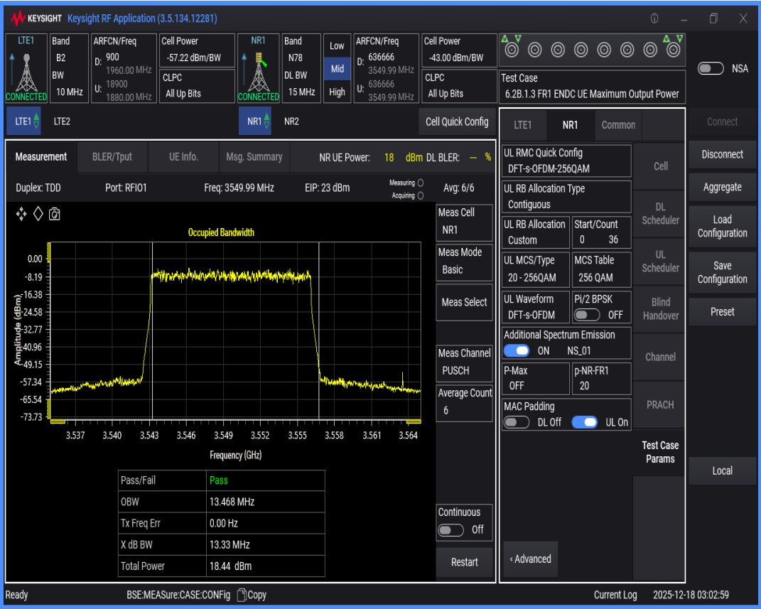
n78 SCS=30kHz DFT_QAM256 BW=20MHz Channel=636666 RB=50@0
