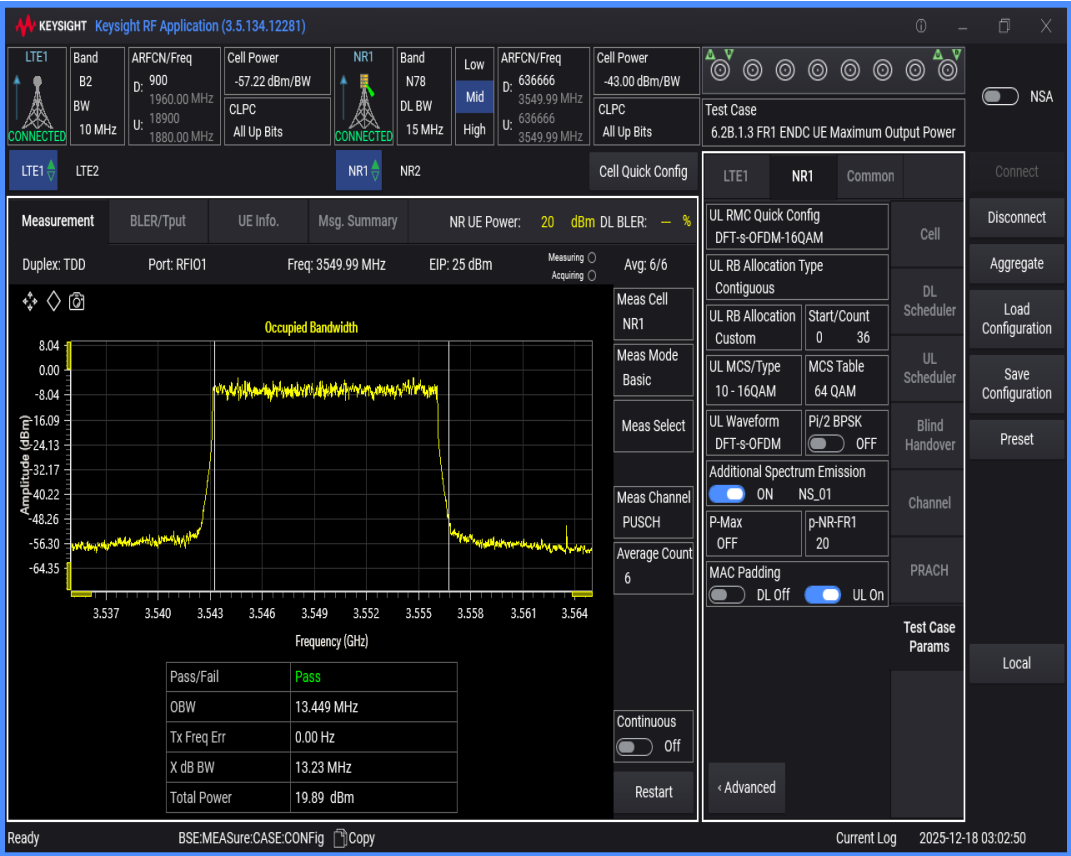
n78 SCS=30kHz DFT_QAM16 BW=20MHz Channel=636666 RB=50@0
