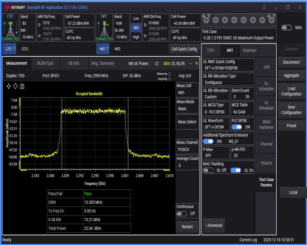
n38 SCS=30kHz DFT_BPSK BW=20MHz Channel=519000 RB=50@0
