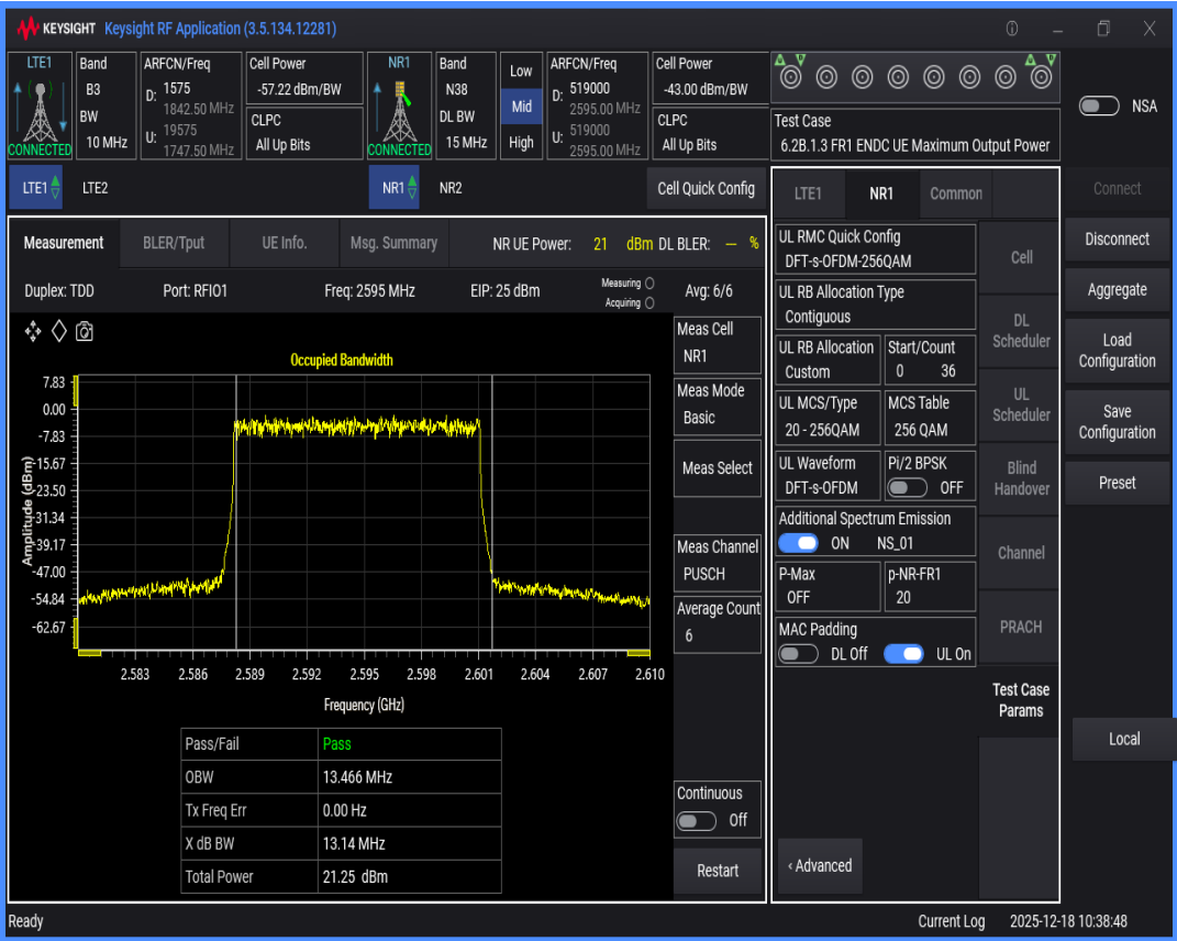
n38 SCS=30kHz DFT_QAM256 BW=20MHz Channel=519000 RB=50@0
