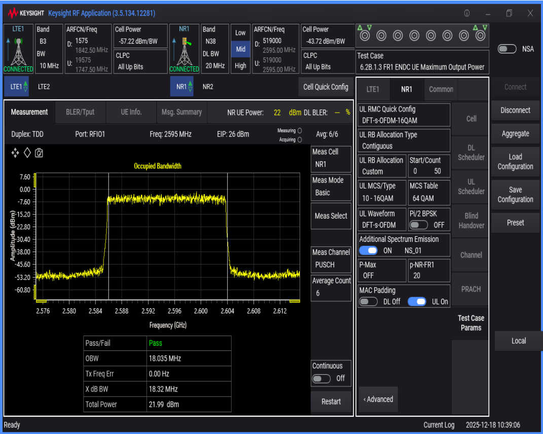
n38 SCS=30kHz DFT_QAM256 BW=10MHz Channel=519000 RB=24@0
