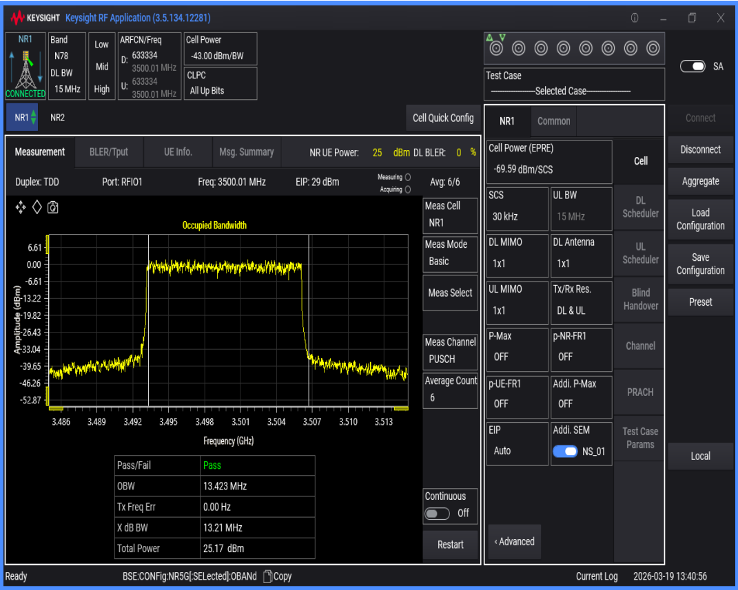
n78(3450-3550) SCS=30kHz DFT_QPSK BW=20MHz Channel=633334 RB=50@0
