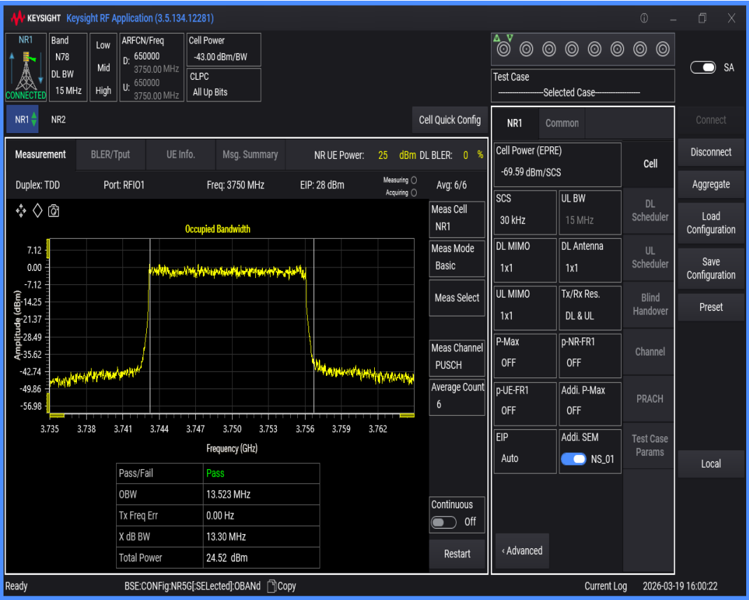
n78(3700-3800) SCS=30kHz DFT_QPSK BW=20MHz Channel=650000 RB=50@0
