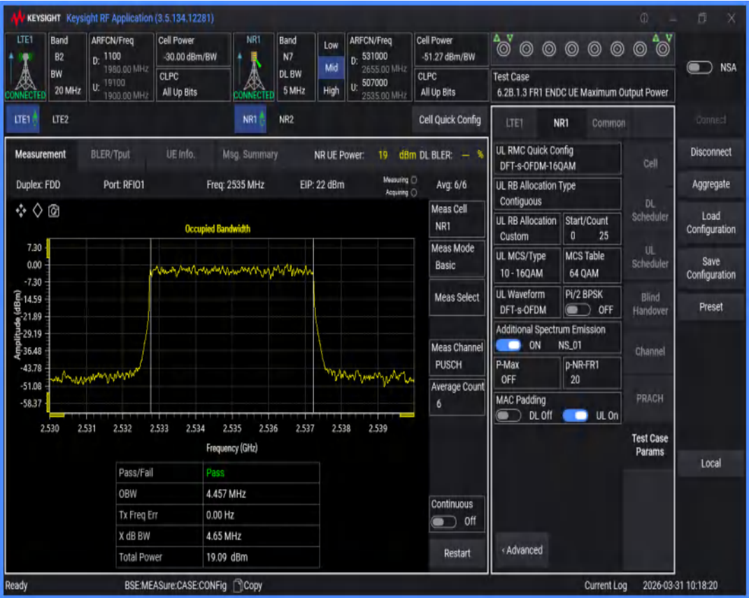
n7 SCS=15kHz DFT_QAM256 BW=10MHz Channel=507000 RB=50@0
