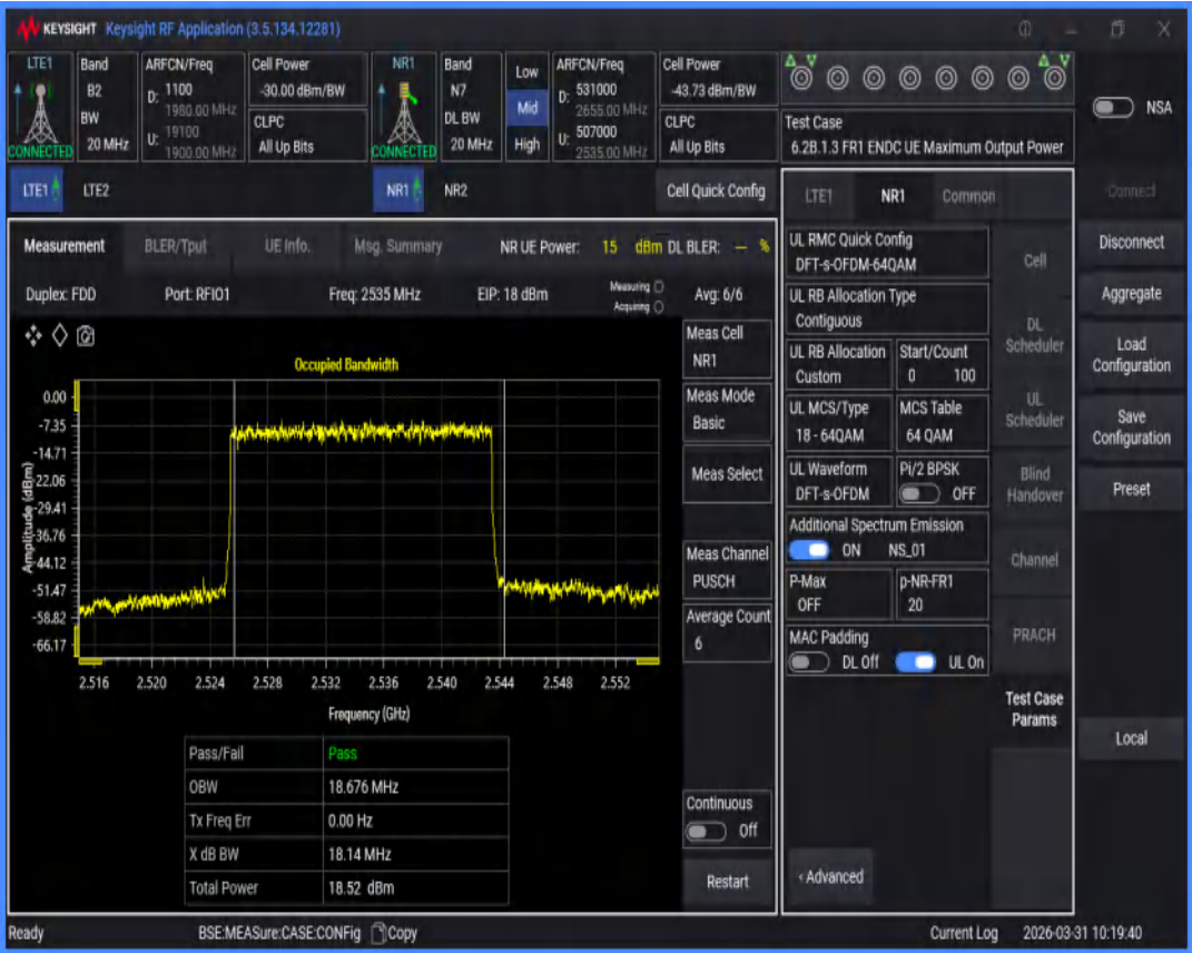
n7 SCS=15kHz DFT_QPSK BW=5MHz Channel=507000 RB=25@0
