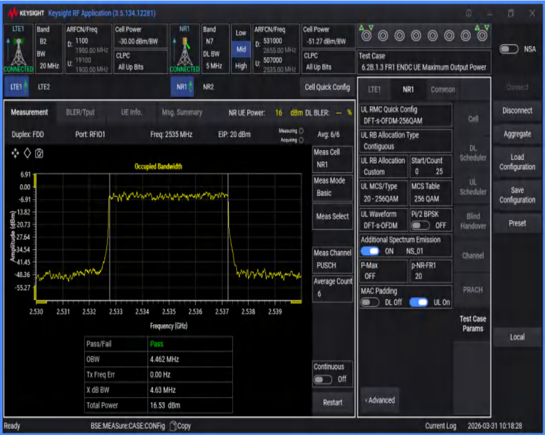
n7 SCS=15kHz DFT_QAM64 BW=10MHz Channel=507000 RB=50@0
