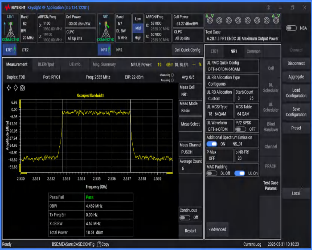
n7 SCS=15kHz DFT_QPSK BW=10MHz Channel=507000 RB=50@0
