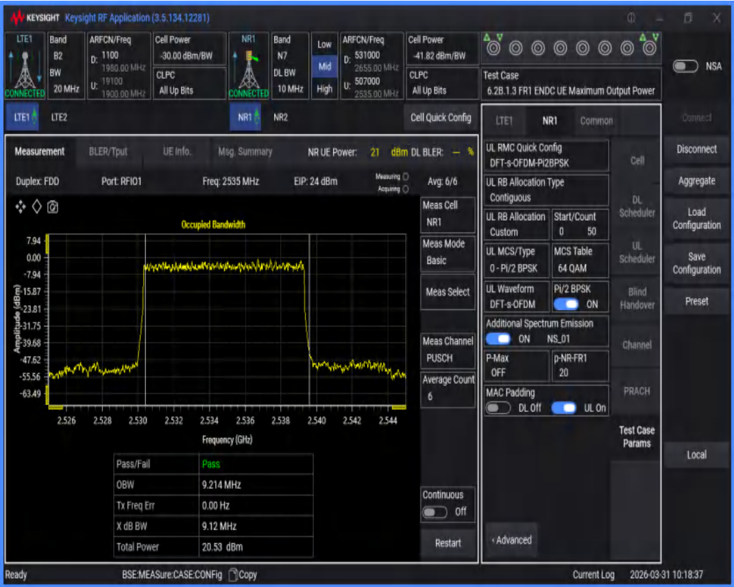
n7 SCS=15kHz DFT_QAM16 BW=10MHz Channel=507000 RB=50@0
