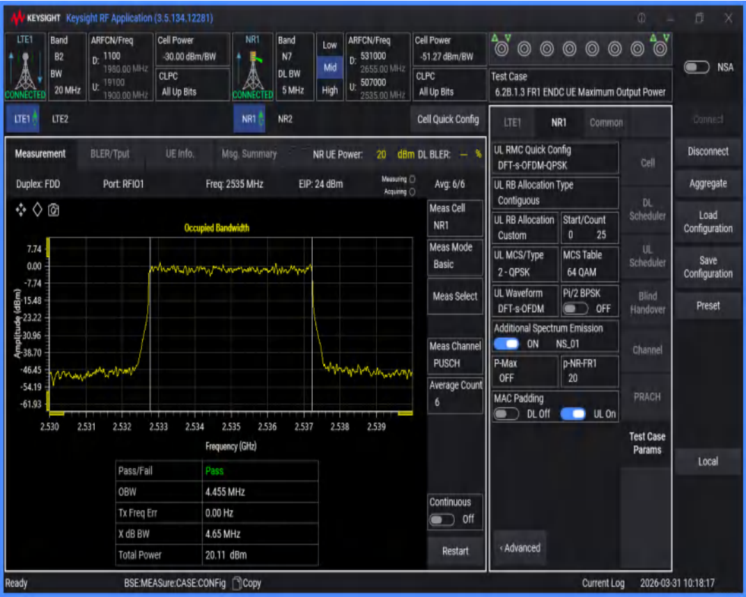
n7 SCS=15kHz DFT_QPSK BW=20MHz Channel=507000 RB=100@0
