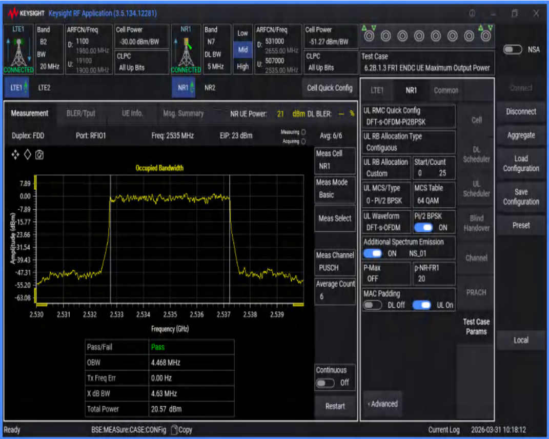
n7 SCS=15kHz DFT_QAM256 BW=20MHz Channel=507000 RB=100@0
