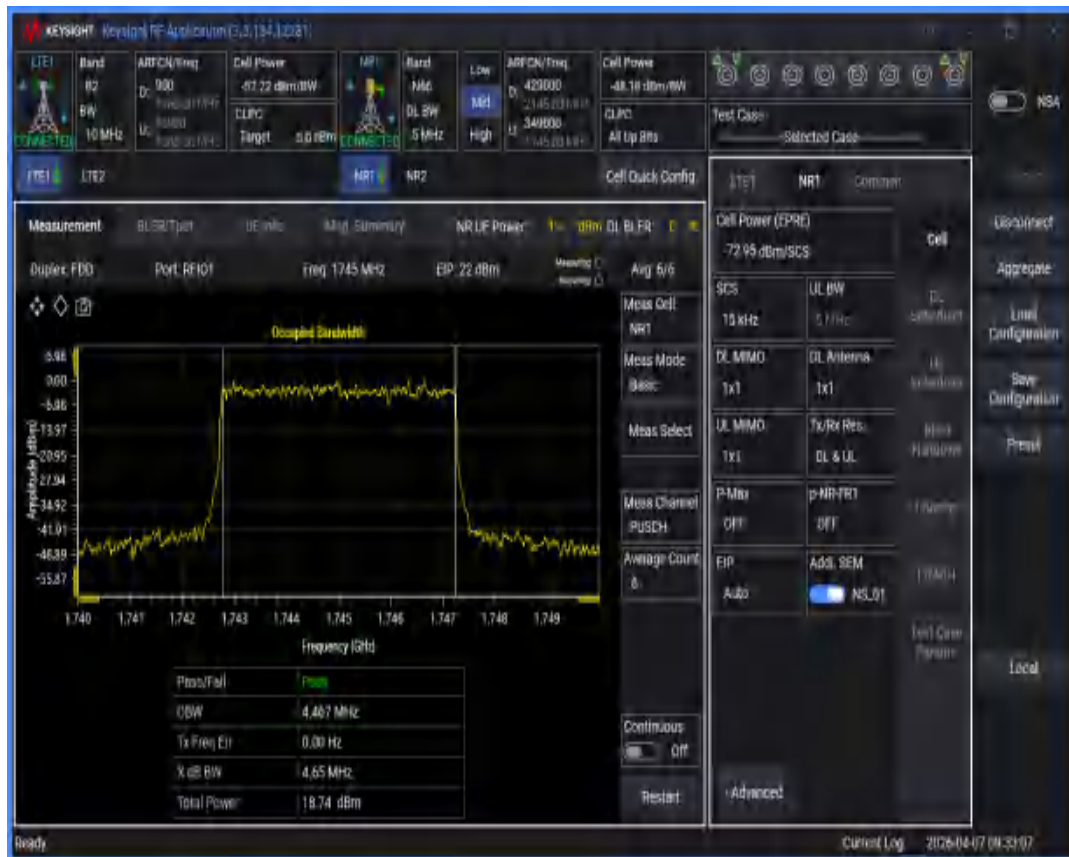
n66 SCS=15kHz DFT_QAM64 BW=10MHz Channel=349000 RB=50@0
