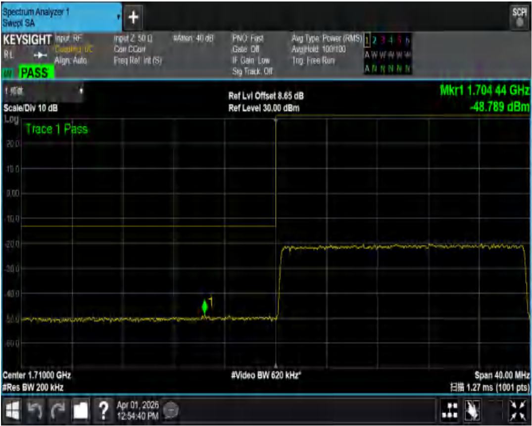
n66 SCS=15kHz CP_QPSK BW=20MHz Channel=344000 RB=1@105
