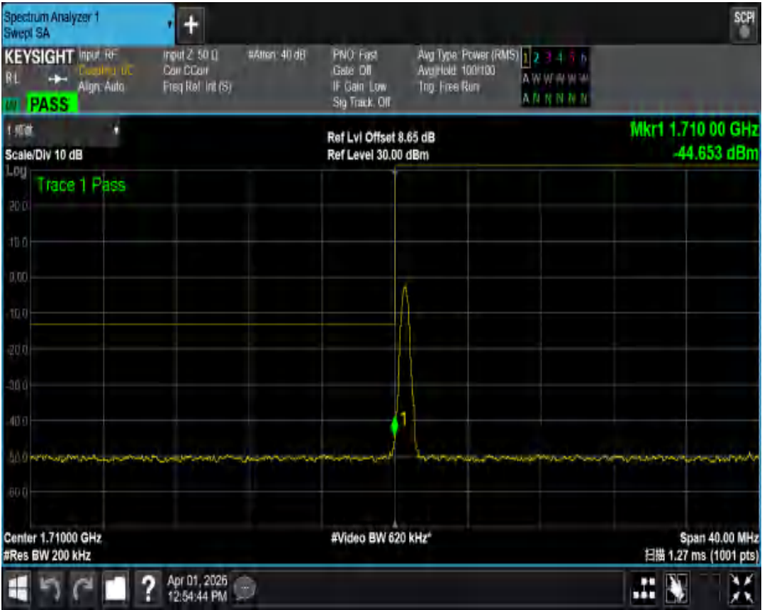
n66 SCS=15kHz CP_QPSK BW=20MHz Channel=344000 RB=106@0
