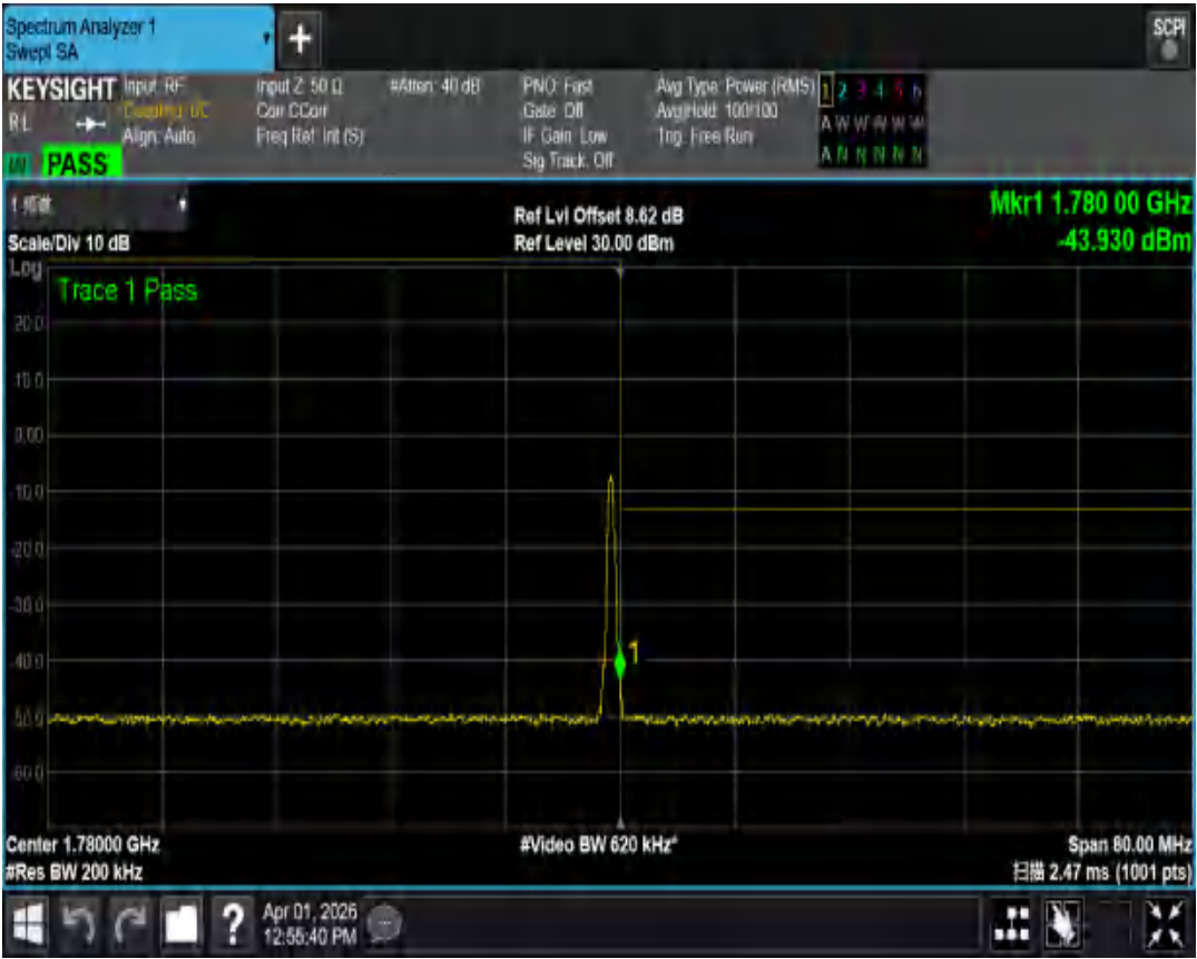
n66 SCS=15kHz CP_QPSK BW=40MHz Channel=352000 RB=1@0
