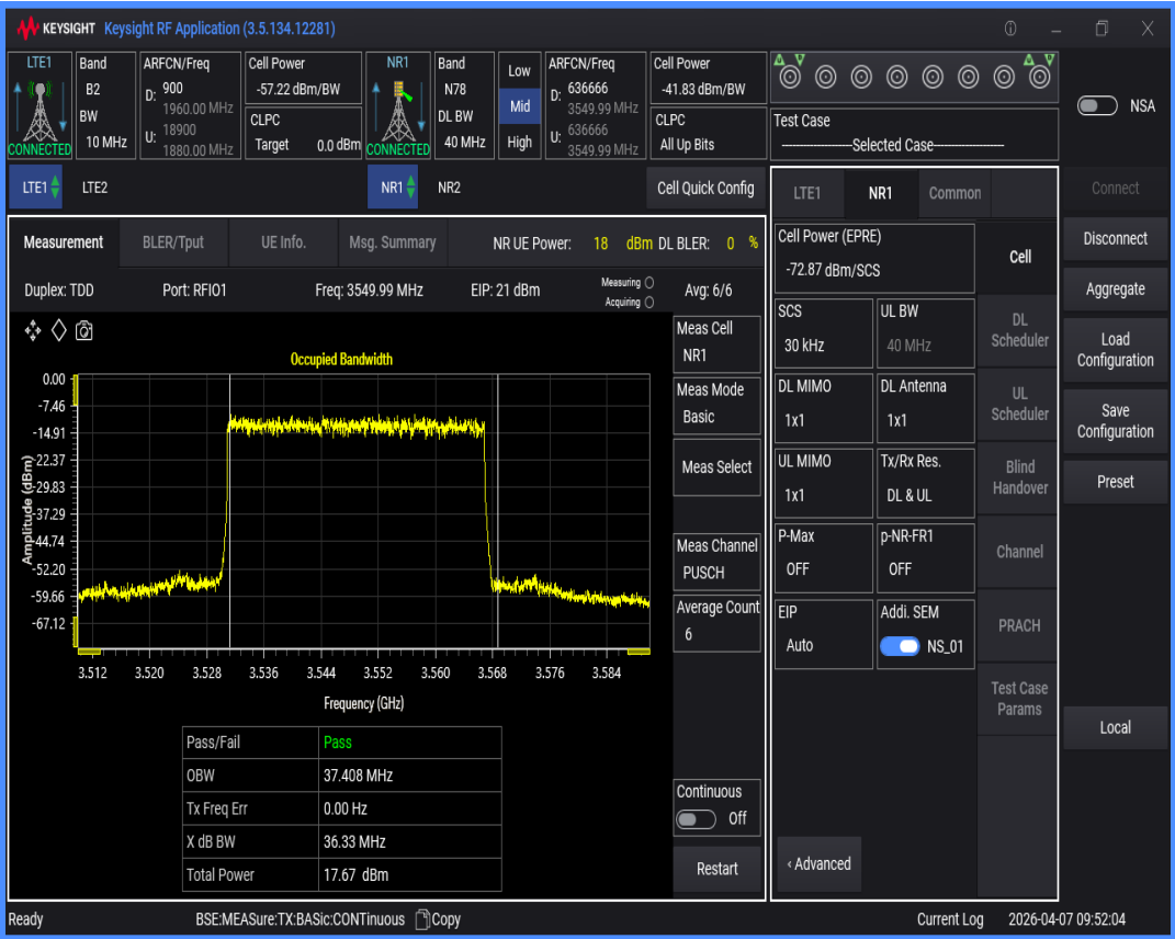
n78 SCS=30kHz DFT_QAM256 BW=20MHz Channel=636666 RB=50@0
