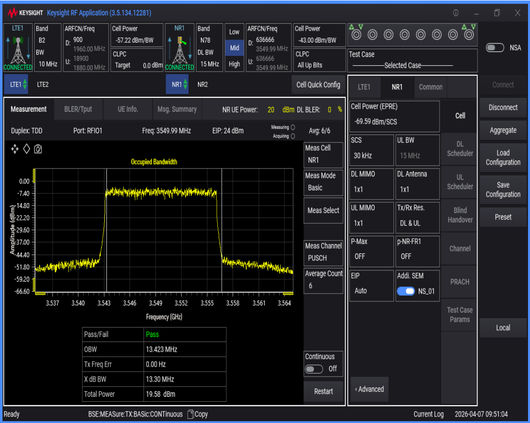
n78 SCS=30kHz DFT_QAM64 BW=20MHz Channel=636666 RB=50@0
