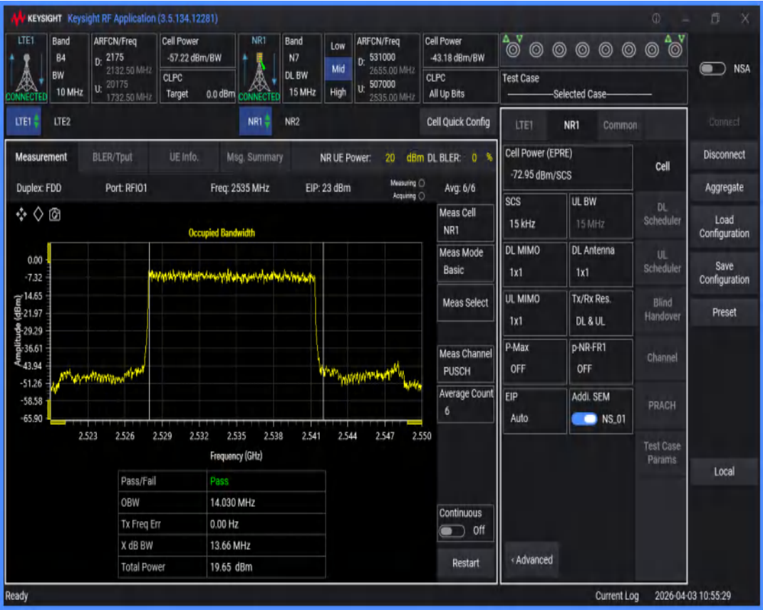
n7 SCS=15kHz DFT_BPSK BW=20MHz Channel=507000 RB=100@0
