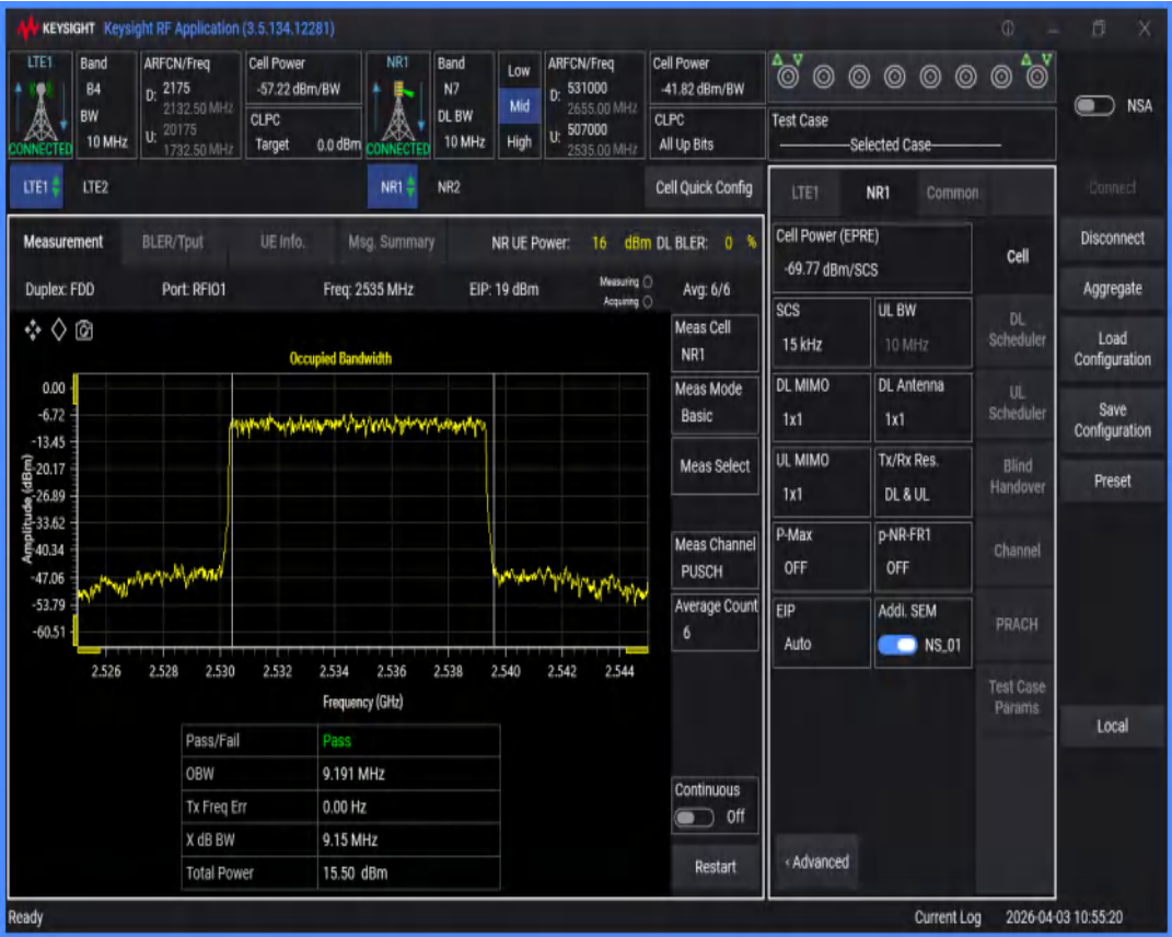
n7 SCS=15kHz DFT_QAM256 BW=20MHz Channel=507000 RB=100@0
