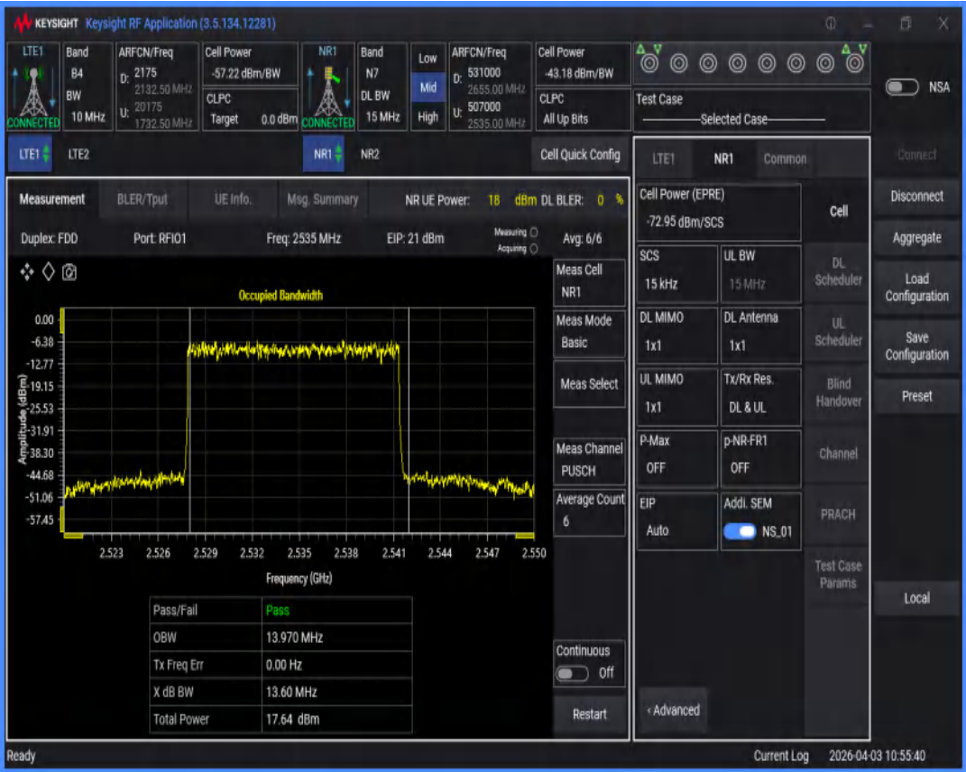
n7 SCS=15kHz DFT_QPSK BW=10MHz Channel=507000 RB=50@0
