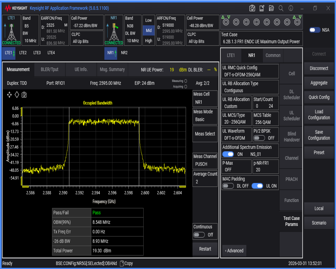
n38 SCS=30kHz DFT_QAM16 BW=20MHz Channel=519000 RB=50@0
