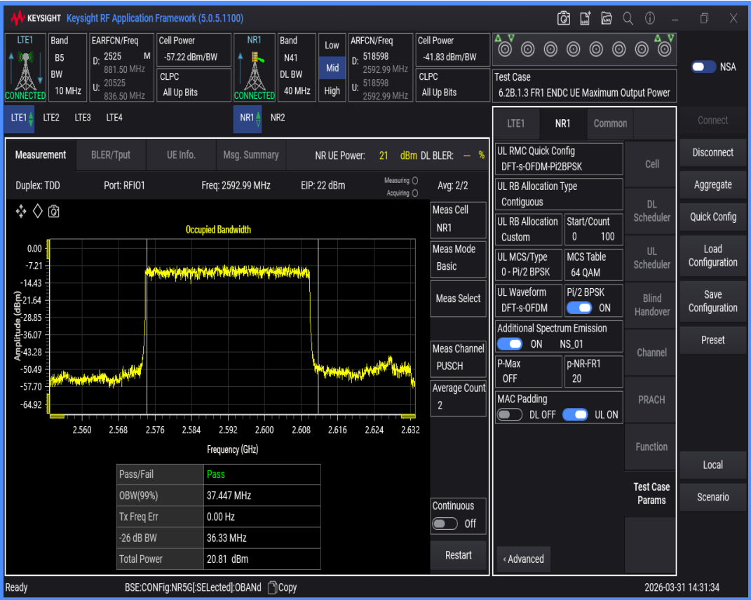
n41 SCS=30kHz DFT_BPSK BW=20MHz Channel=518598 RB=50@0
