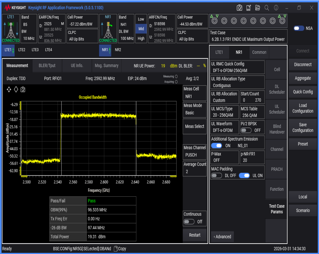
n41 SCS=30kHz DFT_QAM256 BW=20MHz Channel=518598 RB=50@0
