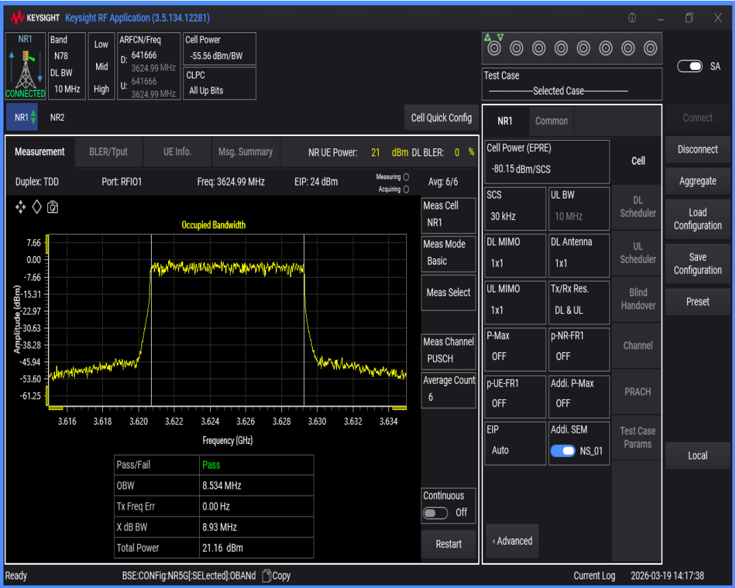
n78(3550-3700) SCS=30kHz DFT_QAM256 BW=20MHz Channel=641666 RB=50@0
