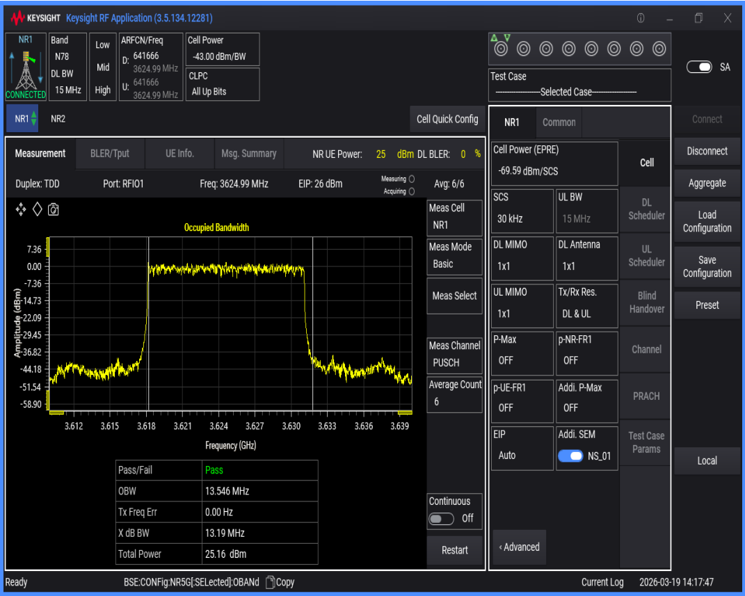
n78(3550-3700) SCS=30kHz DFT_BPSK BW=20MHz Channel=641666 RB=50@0
