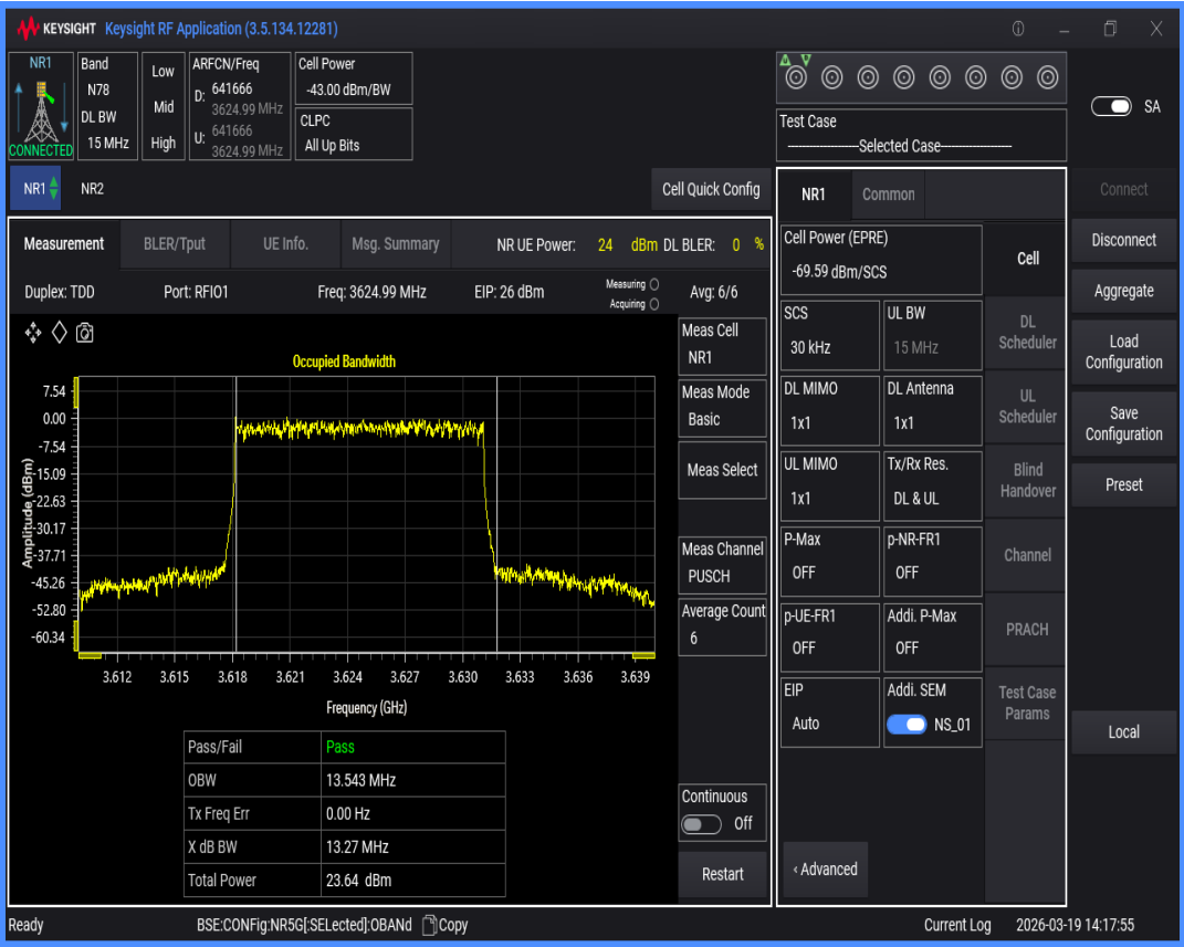
n78(3550-3700) SCS=30kHz DFT_QAM16 BW=20MHz Channel=641666 RB=50@0
